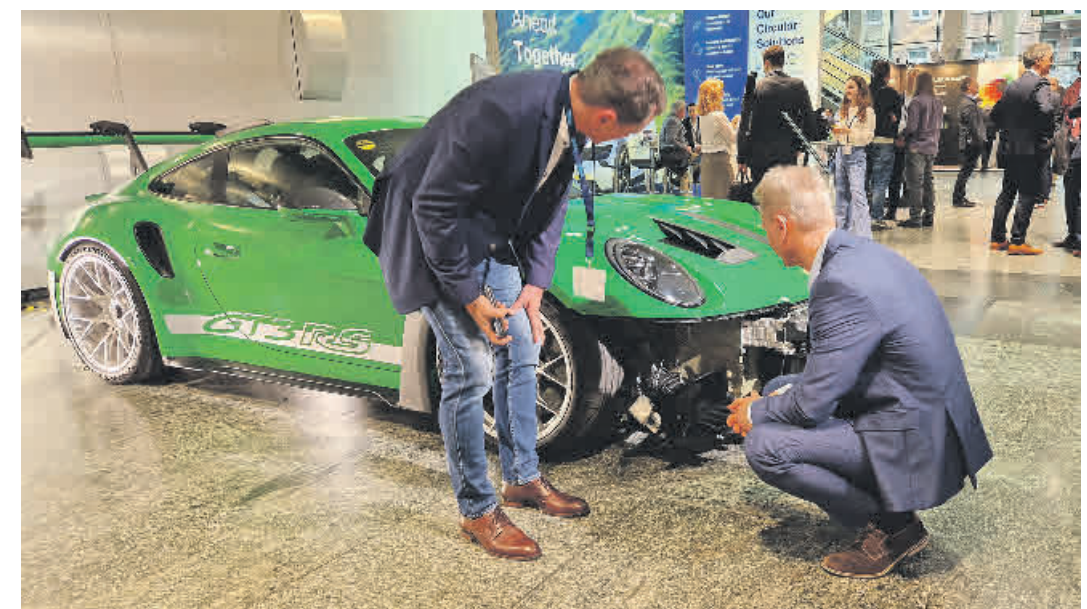
Von der Rennstrecke auf die Straße – von Interesse für die Kongressbesucher war der adaptive Frontdiffusor im Porsche 911. Er passt sich in Millisekunden den Gegebenheiten einer Strecke an. Foto: Peter Kellerhoff
