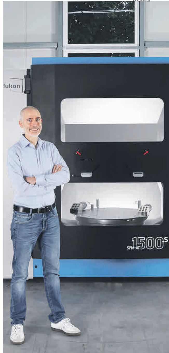
Solukon-Chef Andreas Hartmann vor einer Entpulverungsanlage, die bis 2100 kg schwere Bauteile aufnehmen kann. Genutzt wird sie u. a. für Raketentriebwerke. Foto: Solukon
