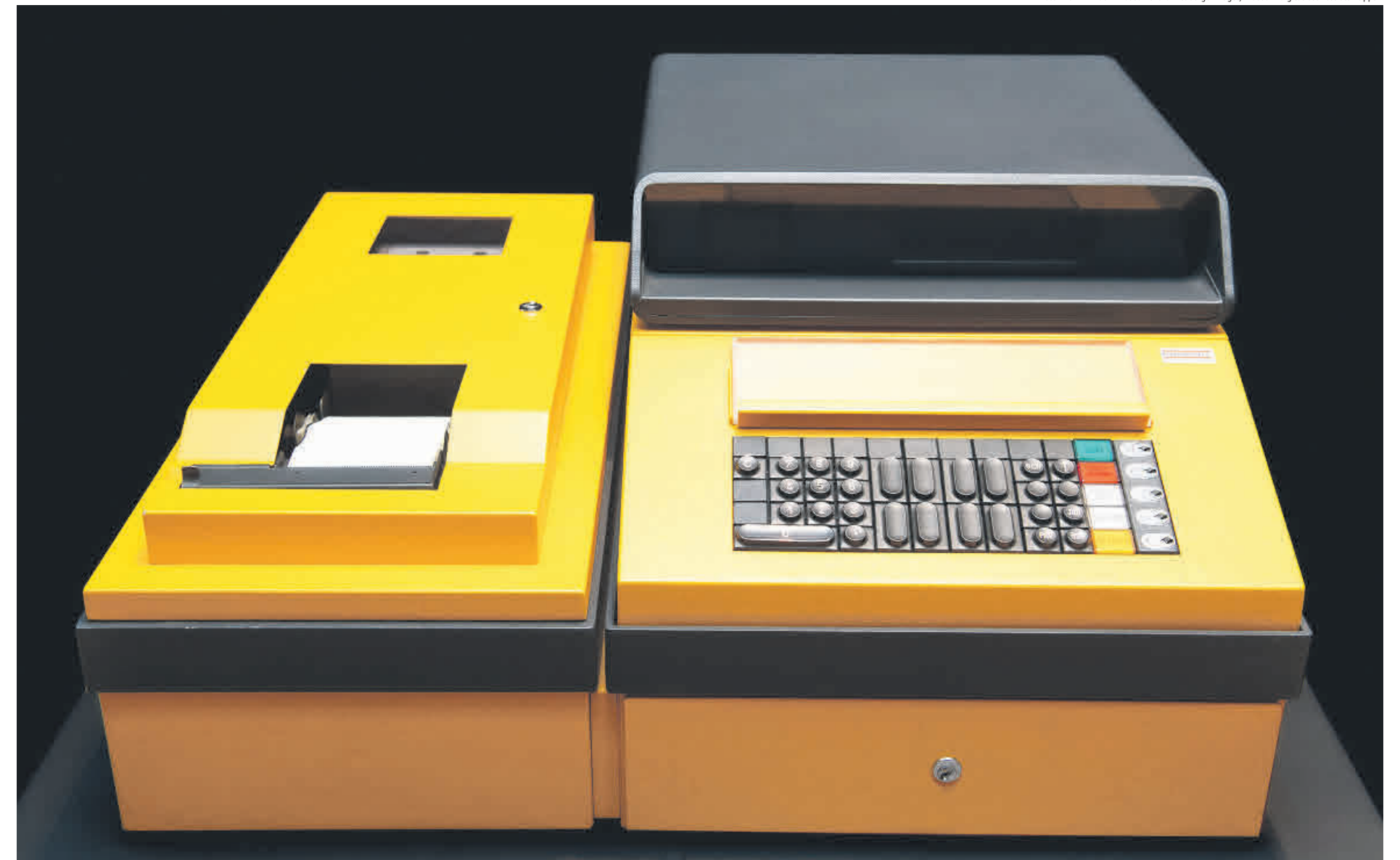
1972 integrierte Nixdorf mit dem System 710 erstmals einen Computer in ein Kassensystem. Von 1973 bis 1981 wurden 4500 Systeme produziert. Zu den ersten Kunden der Nixdorf Computerkasse zählten Photo Porst, Hettlage, Kaufhof und Wienerwald. Die Computerkasse 710 ist modular zu einer Einheit zusammengefasst: Zentraleinheit, bestehend aus Rechner und Datenspeicher, Bedientastatur, Bedienanzeige, Führungsanzeige, Kassenschublade, verschiedene Kassendruckwerke und eine Magnetband-Kassetteneinheit.
