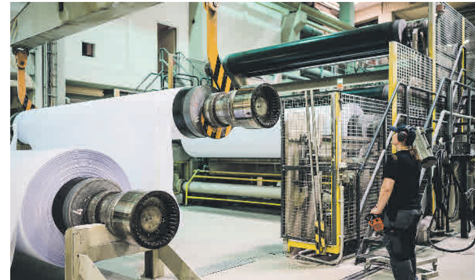
Das Papier läuft in kilometerlangen Bahnen durch verschiedene Maschinen. Dabei ist es anfangs noch sehr feucht und muss getrocknet werden, bevor es aufgerollt wird. Foto: Fotografie Bokelmann
