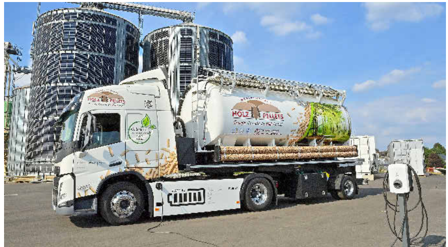
Mit einer 450-kWh-Batterie und 500 kW Antriebsleistung hat der Pellet-Lkw eine Reichweite von rund 250 bis 300 km inklusive der Energie für den Nebenantrieb. Foto: Mann Energie
