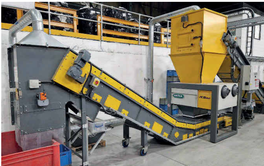
Das Unternehmen The Royal Mint nutzt drei dieser Untha-RS30-Maschinen, um Leiterplatten zu zerkleinern und auf die nachfolgenden Prozessschritte vorzubereiten. Foto: Untha
