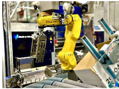
Der Roboter , der die fertigen Müllsackrollen in Kartons verpackt. Foto: Polifilm
