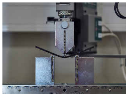
Ein Kunststoffprodukt , UBQ enthaltend, wird im betriebseigenen Labor in Bergen op Zoom, Niederlande, daraufhin getestet, wie flexibel es auf Druck reagiert. Foto: UBQ Materials
