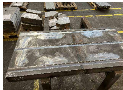
Auf der Rückseite beider Doppelplatten wurden jeweils drei Messbahnen gefräst. Foto: Jebens
