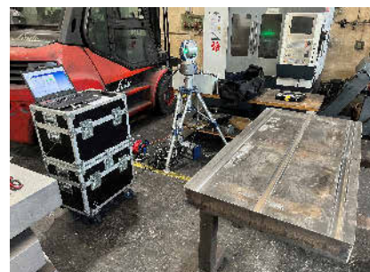
Vor der Entspannung wurden Messpunkte per Laser vermessen. Diese Messung dient als Referenz für den Urzustand. Foto: Jebens
