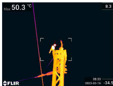
Bild 2 Höchste Präzision ist bei der Arbeit mit dem Teleobjektiv notwendig. Schließlich möchte man die Temperatur des Bauteils, nicht die des darauf sitzenden Vogels erfassen. Fotos: Teledyne Flir
