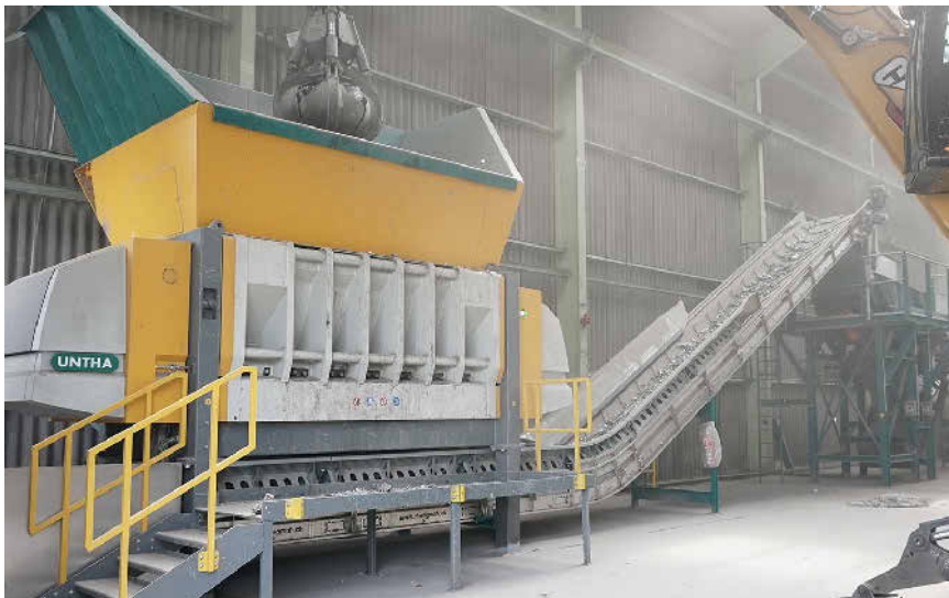
Der Zerkleinerer XR3000C der österreichischen Firma Untha in Betrieb bei der Karl Karletshofer GmbH in Neu-Ulm. Er ist Ausgangspunkt einer Komplettanlage, in der Metalle zerkleinert und anschließend in sortenreine Materialfraktionen sortiert werden. Foto: Untha
