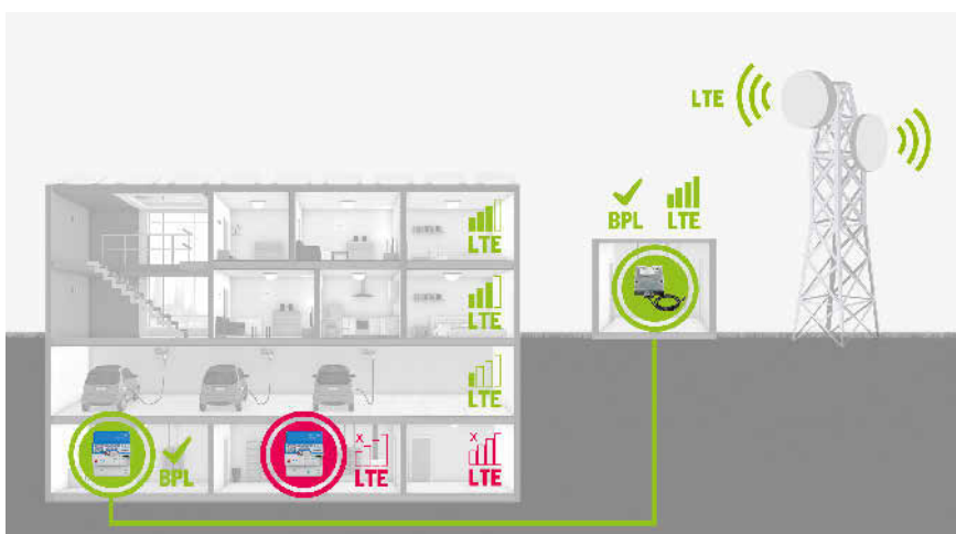
Das Breitband-Powerline (BPL)-System der Power Plus Communications AG (PPC) macht das Stromnetz zur effektiven und sicheren Kommunikationsplattform für digitale Anwendungen im Verteilnetz. Grafik: PPC
