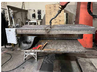
Je zwei Platten wurden per Hand aneinander geheftet und mit einem Schweißroboter zu Doppelplatten verschweißt. Foto: Jebens
