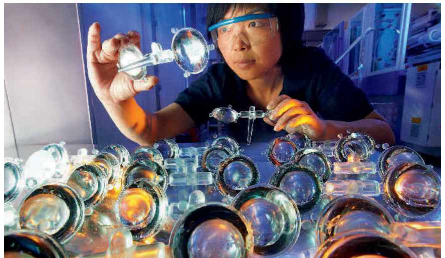
Mit dem richtigen Design können Autoscheinwerfer vollständig aus dem Hochleistungskunststoff Polycarbonat hergestellt werden. Linsen wie im Bild zu sehen sind dabei eines von mehreren Bauteilen. Foto: Covestro
