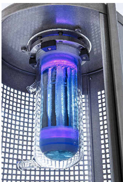
Zugproben aus Elastomermaterial in einem Glasautoklaven. Die Proben werden bei hoher Temperatur mit Lauge umspült. Kommen hohe Drücke hinzu, wird ein Stahlautoklav genutzt. Foto: Fraunhofer LBF/Ursula Raapke
