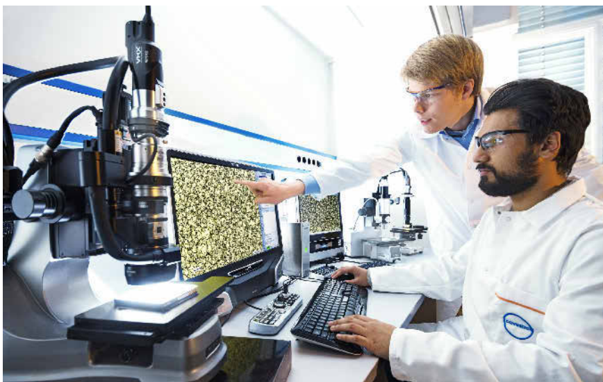
„Design for Circularity“ kann bedeuten, die Leistungsfähigkeit und Haltbarkeit von Materialien mit digitaler Mikroskopie zu verbessern, damit diese seltener getauscht werden müssen. Hier analysieren Mitarbeiter von Covestro die Struktur von Polyurethan-Hartschaum zum Isolieren von Kühlschränken.
