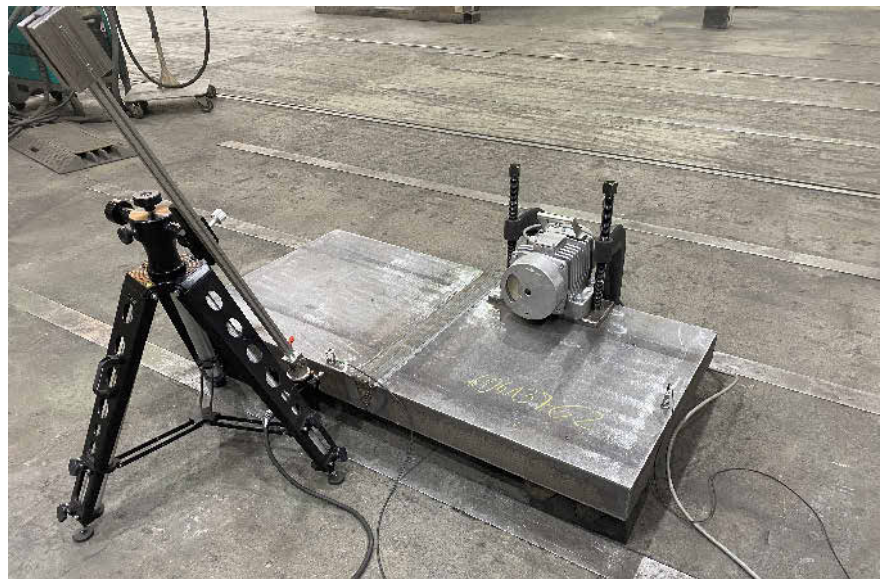
Das Unternehmen Jebens in Korntal-Münchingen hat im Rahmen eines Vergleichsversuchs dieses Werkstück im Frühjahr 2024 vibrationsentspannt. Hinter dem Bauteil ist der Vibrationsmotor zu sehen, davor das Stativ mit dem Modalhammer. Ein identisches zweites Werkstück wurde währenddessen spannungsarm gegläht. Foto: Jebens
