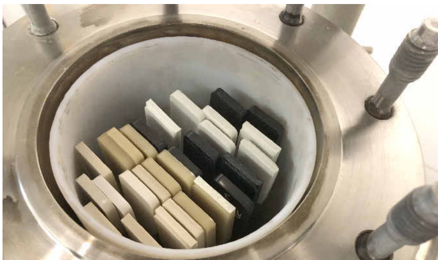
Probekörper im Autoklaven vor dem druckdichten Verschließen des Prüfsystems. Nach der Alterung über einige 100 Stunden werden die Proben entnommen und in mechanischen Zugversuchen geprüft. Foto: Fraunhofer LBF
