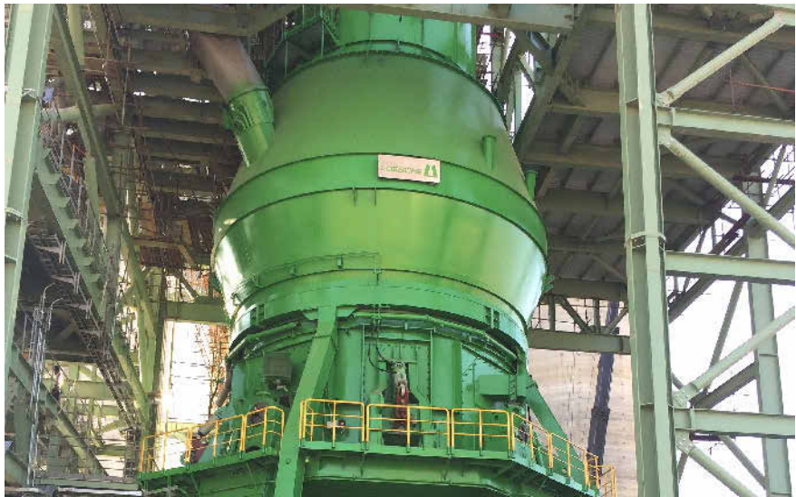
Die im Technikum der Loesche GmbH für das „Emsarzem“-Projekt gemahlene Müllverbrennungsschlacke kann großtechnisch in Industriemöhlen dieser Art gemahlen werden. Foto: Loesche
