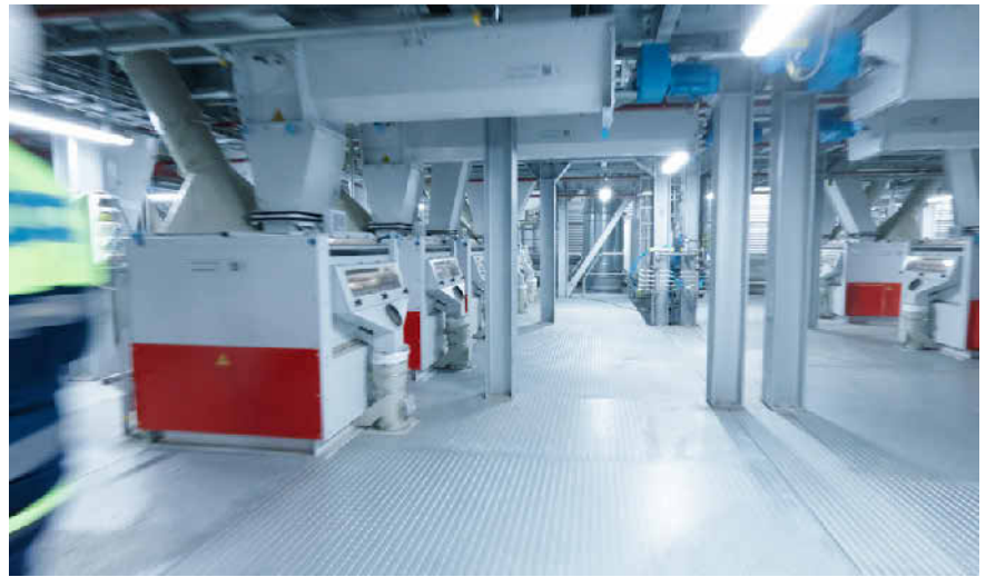
UBQ Materials trennt in dieser Werkshalle in Bergen op Zoom in den Niederlanden den Abfall mit „air tables“ von Glas, Steinen und anderen mineralischen Bestandteilen. Foto: UBQ Materials
