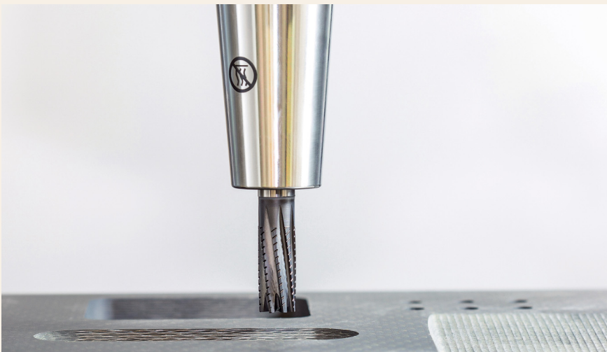
Bild 3 Die homogene CVD-Diamantbeschichtung von Mapal sorgt für lange Standzeiten und hohe Prozesssicherheit, zum Beispiel beim OptiMill-Composite-Speed-Plus Vollhartmetallfräser für CFK-Werkstoffe. Foto: Mapal
