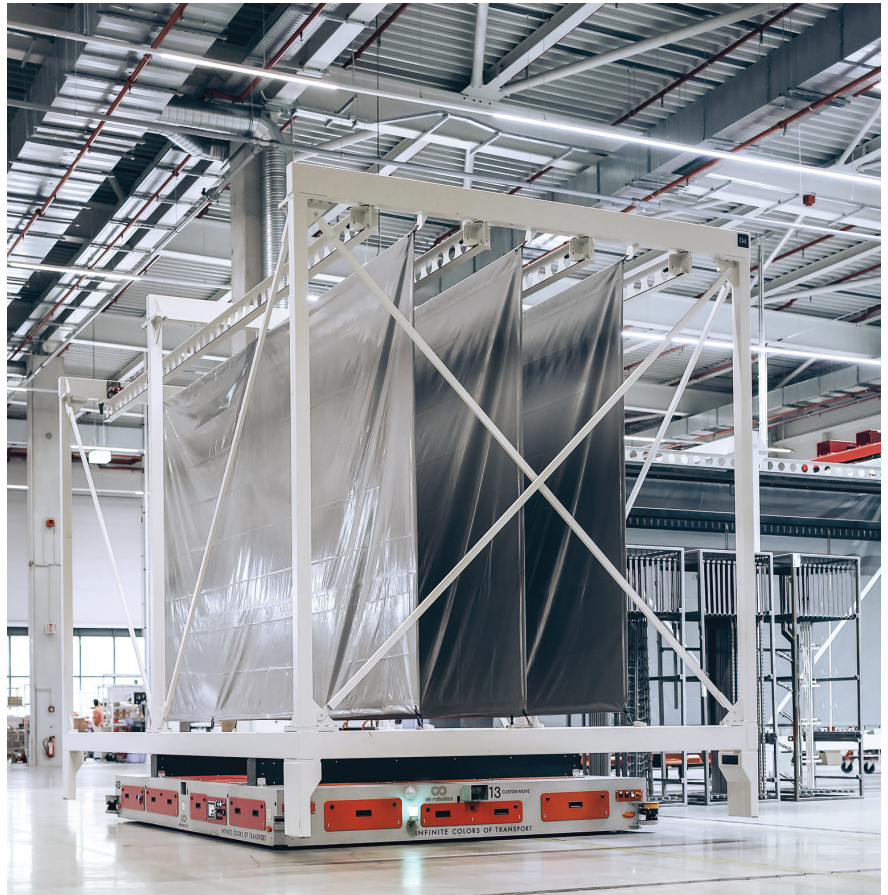
Bild 2: Drei Custom Move Transportrobotern verknüpfen bei Warema die Blechfertigung mit der Pulverbeschichtungsanlage und sorgt für optimale Materialflüsse. Foto: ek robotics
