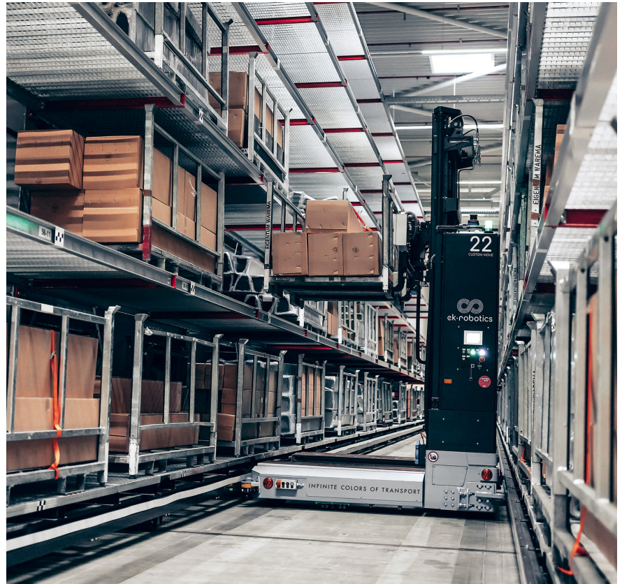
Bild 5: Für eine fehlertolerante Lastaufnahme sind die zwei FTF mit 3D-Objekterkennung ausgestattet. Die von ek robotics entwickelte Software ist in der Lage, eine Vielzahl an Paletten- und Lasttypen zu klassifizieren, auszumessen und gleichzeitig eine Belegt-Prüfung bei Lastabgabe durchzuführen. Foto: ek robotics
