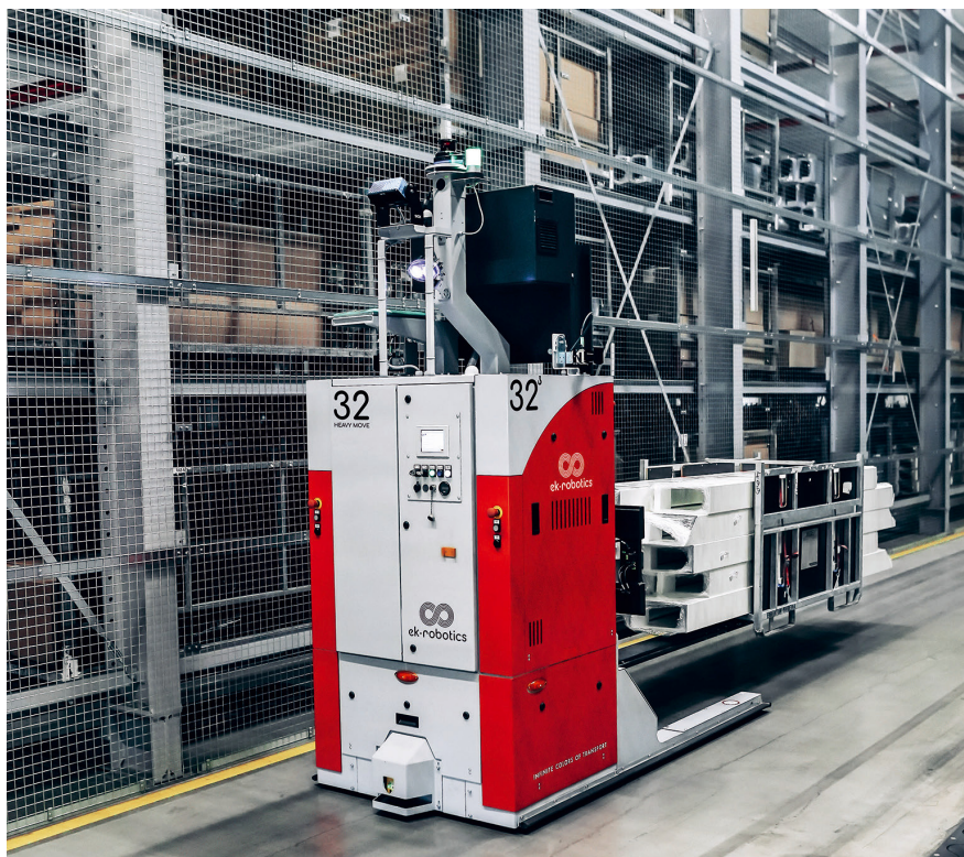
Bild 3: Heavy Move mit Sondergabeln für Lasten bis 4,3 m Länge transportieren Fertigprodukte bis hin zur Verladung. Foto: ek robotics
