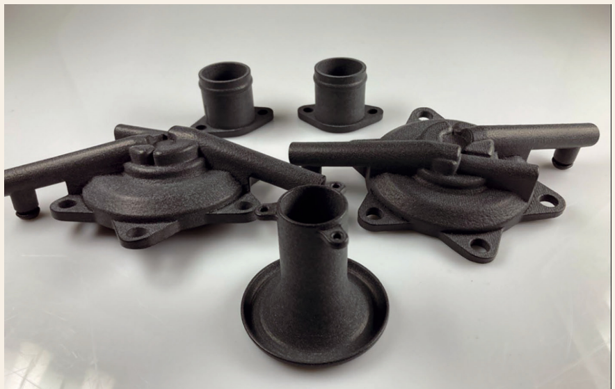
Lasergesinterte Bauteile aus Luvosint PA613 9711 CF. Foto: Lehvoss Group
