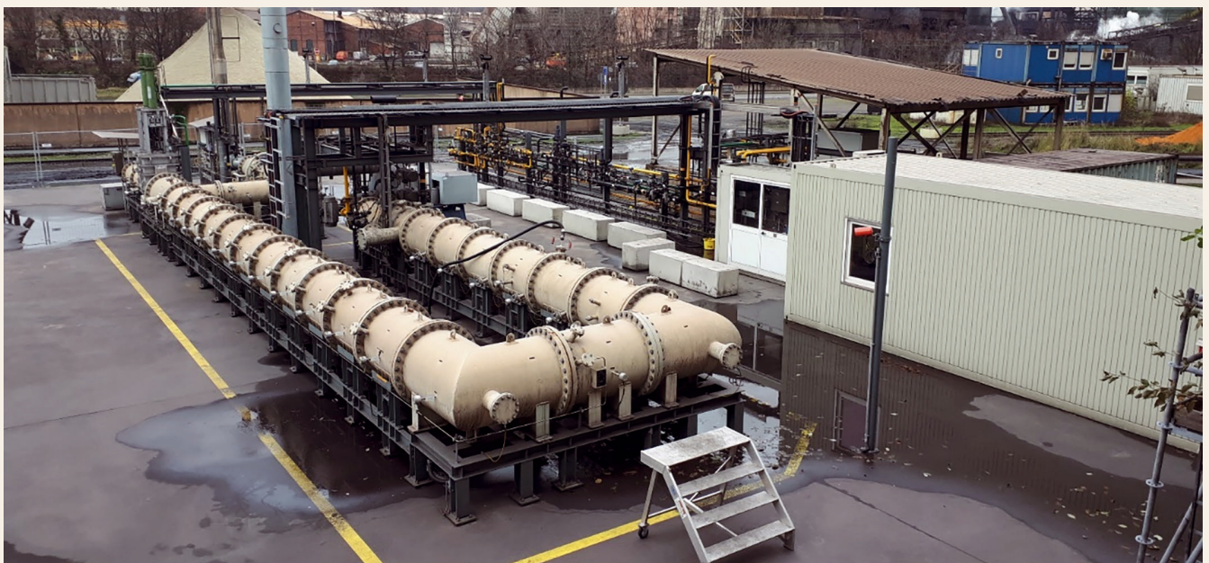
Bild 2 Pilotanlage im Saarland, mit der das neue Verfahren zur Eisengewinnung bereits demonstriert wird. Foto: SMS group
