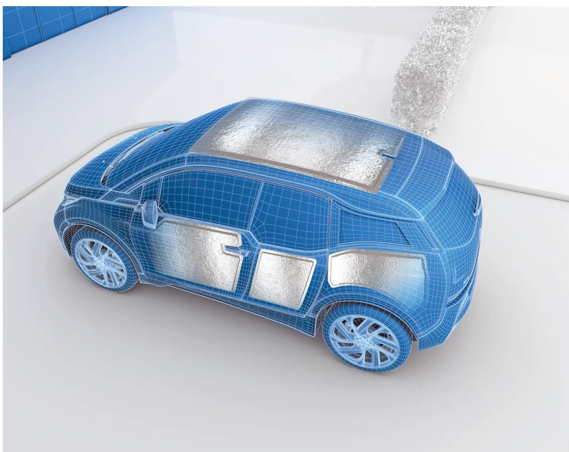
Flexibel anpassbare Vakuumisulationspaneele (VIPs) lassen sich in bestehende Automobil-Designs integrieren. Foto: va-Q-tec AG
