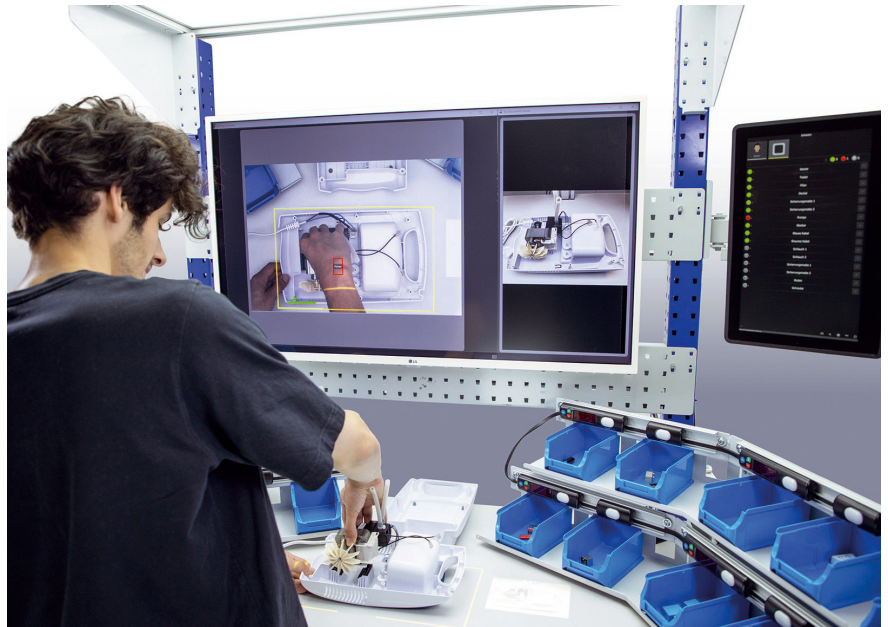
Bild 3: Der Montagearbeitsplatz Ergosmart bietet sich für das Arbeiten mit digitalen Arbeitsanweisungen an. Foto: Krieg
