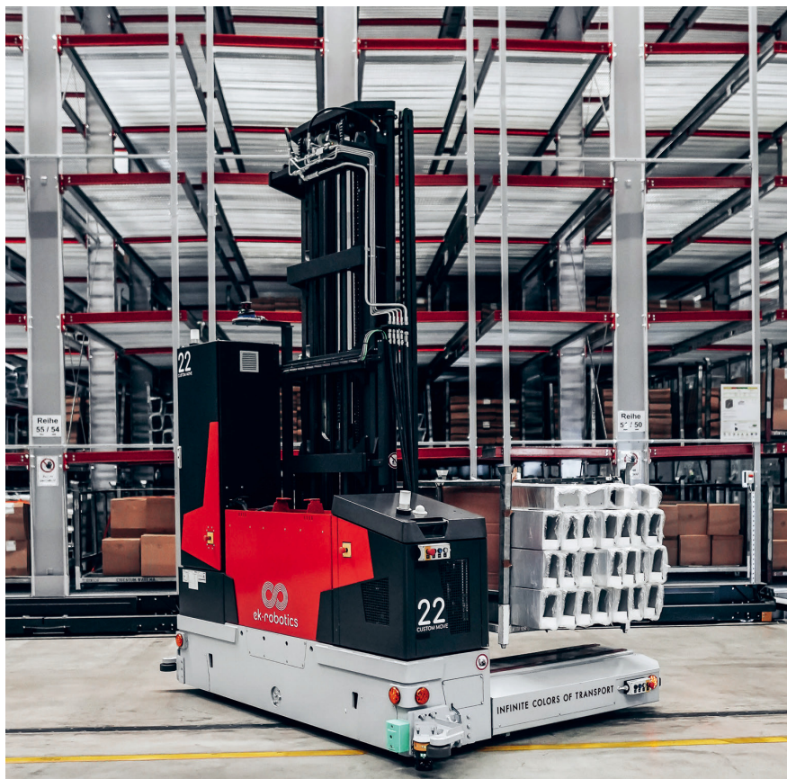
Bild 4: Zwei maßangefertigte 4-Wege-Stapler der Serie Custom Move lagern in Wertheim Waren in acht Metern Höhe im Verschieberegalein. Foto: ek robotics
