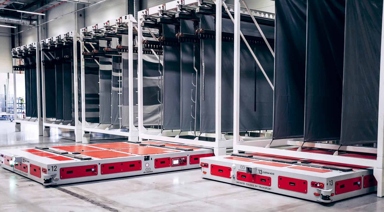
Bild 1: Die maßangefertigten Transportroboter transportieren bei Warema Sonderlastträger mit einem Gewicht bis 4.500 kg. Foto: ek robotics
