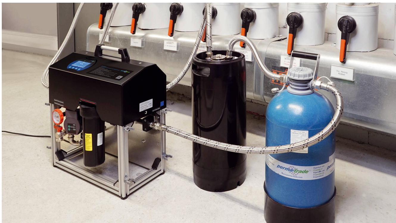
Mit einer Sauerstoffzehrpatrone (im Bild: OxRed von perma-trade) kann nach Art einer „Filterpatrone“ der im Anlagenwasser gelöste Sauerstoff direkt beim Hindurchströmen eliminiert und auf diese Weise Korrosionsproblemen entgegengewirkt werden. Foto: perma-trade
