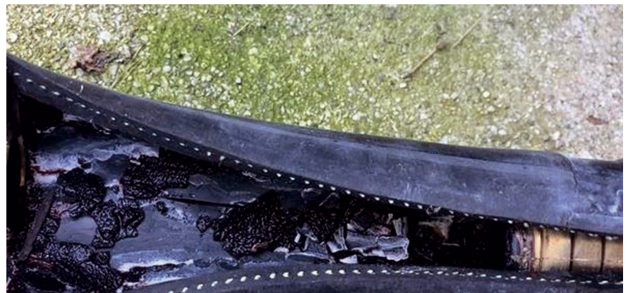
Bild 3: Diffusionsoffener Gummischlauch mit deutlichen Magnetitablagerungen auf der Innenseite. Platzen diese ab, kommt es zu Störungen von BHKWs oder Wärmepumpen. Edelstahlwellrohre schaffen hier Abhilfe. Foto: perma-trade
