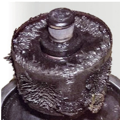
Bild 2: Moderne Nassläuferpumpen reagieren sensibel auf Magnetit im Anlagenwasser. Foto: perma-trade
