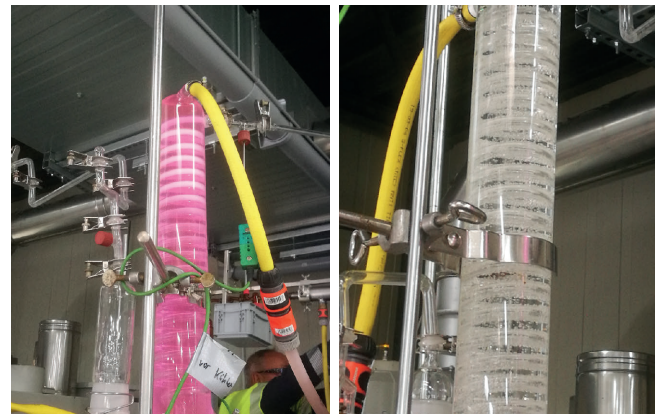
Bild 9. MK 6, zweistufiges KÜhlersystem, Fotos der KÜhlerstufen; links KÜhlerstufe 1; rechts KÜhlerstufe 2, 1. Messtag. Foto: Autoren
