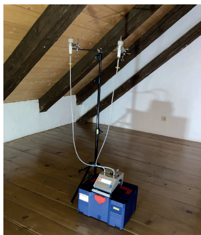
Bild. Raumluftprobenahme in der historischen Thürlmühle auf dem Gelände des Freilichtmuseums Glentleiten. Foto: © Fraunhofer IBP
