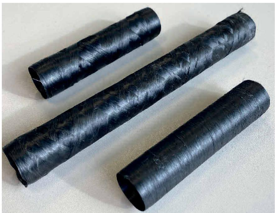
**Bild 2:** Faserverstärkte Rohre, gewickelt mit Umfangs- und Kreuzwickellagen. Foto: Verfasser
