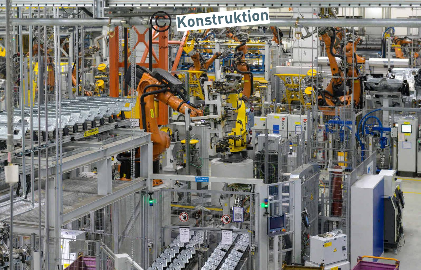
**Bild 1:** Übersicht über die Produktion in Dingolfing. Alle Roboter werden mit Gleichstrom betrieben. Foto: Lapp
