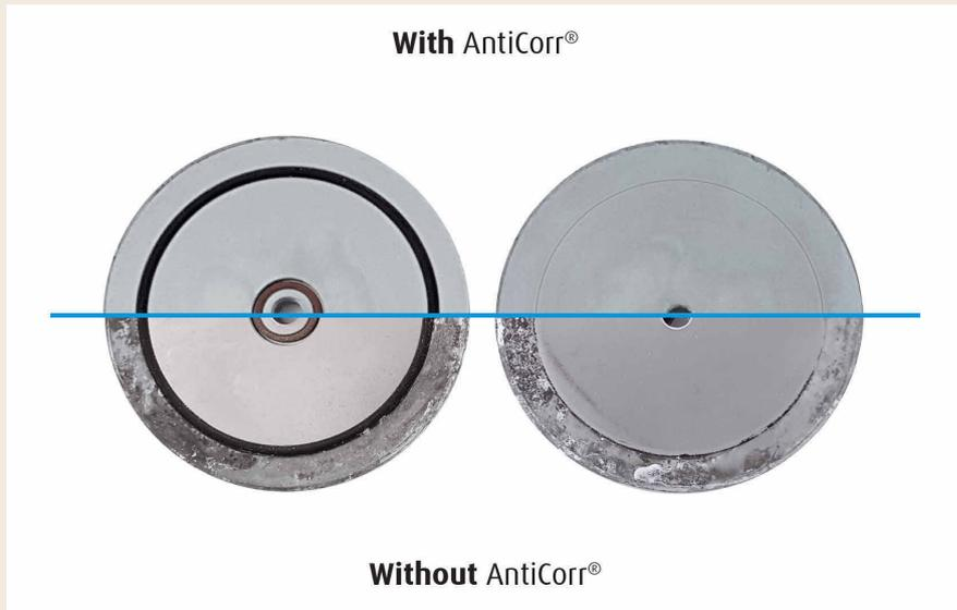
**Bild 2** Aluminium-Druckgusskörper (mit und ohne Plasmabehandlung) nach einem 720-stündigen Salzsprühnebeltest zum Vergleich. Foto: Plasmamatreat GmbH
