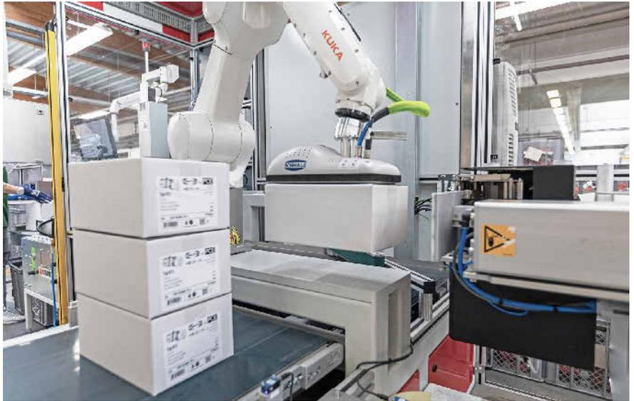
**Bild 2:** Der Greifer FXCB hält, das Etikettiergerät klebt. Das alles läuft automatisch. Foto: J. Schmalz GmbH
