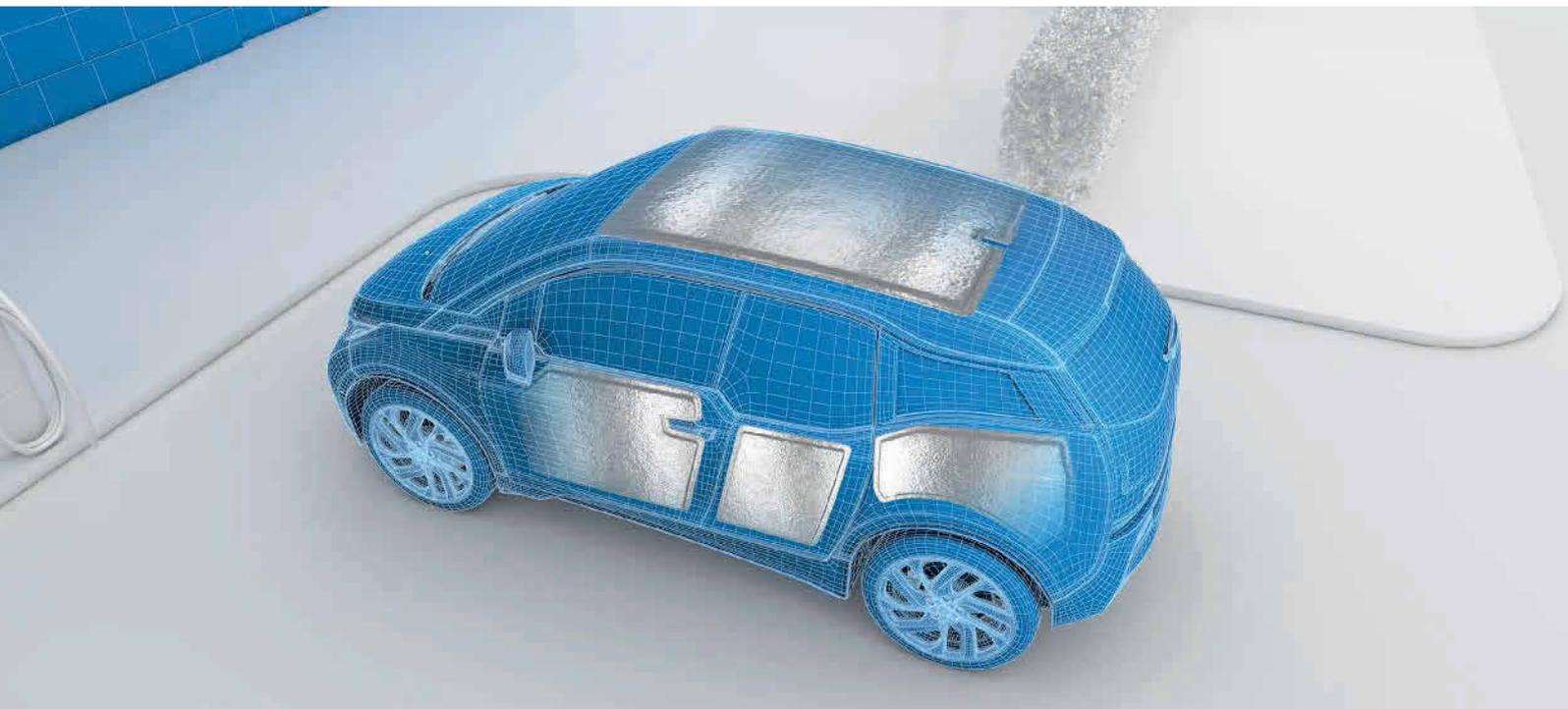
**Bild 1:** Flexibel anpassbare Vakuumisulationspaneele lassen sich in bestehende Automobil-Designs integrieren. Foto: Va-Q-tec AG
