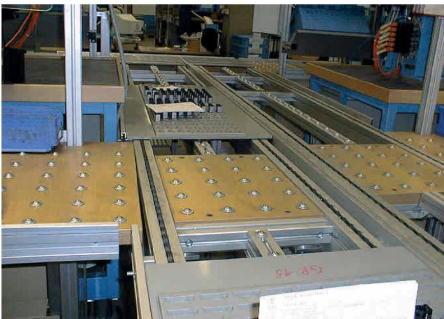
**Bild 1:** Kugelrollen in der Anwendung. Foto: Bosch Rexroth AG
