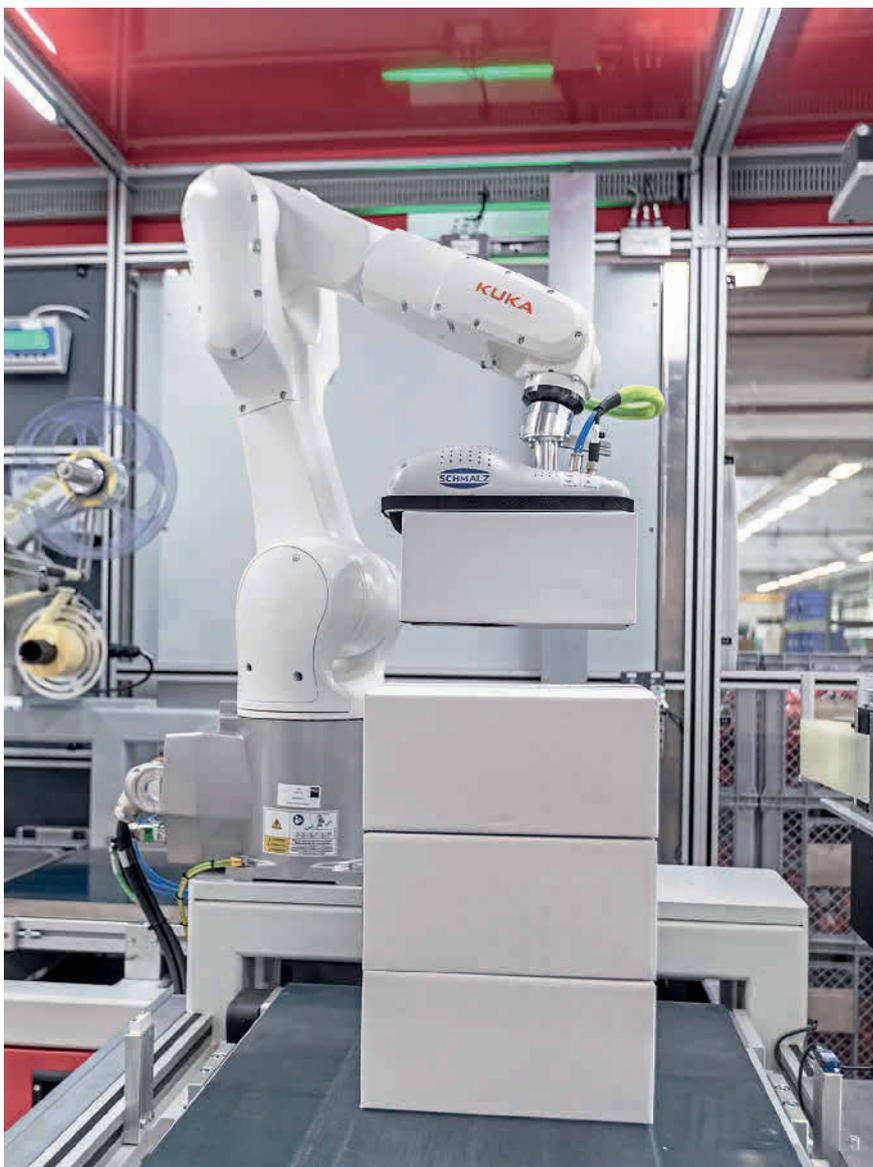
Bild 1: Das Handhabungssystem stapelt die Pakete auf dem Laufband. Foto: J. Schmalz GmbH
