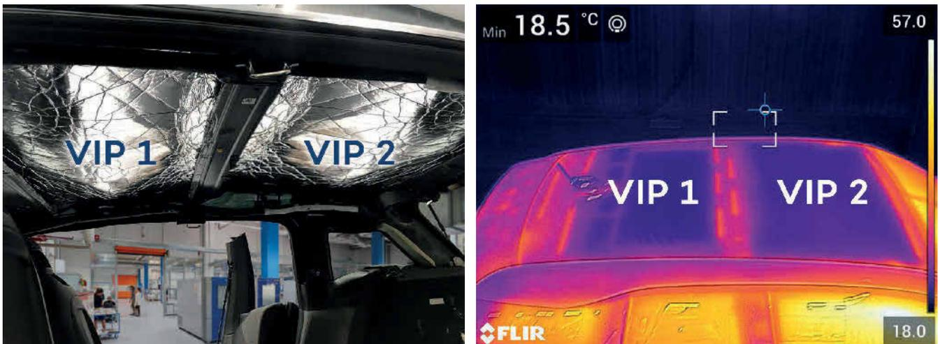
**Bild 2:** Die Wärmebildaufnahme eines mit Vakuumsulationspaneelen gedämmten Dachs zeigt den extrem niedrigen Wärmeverlust bei VIP 1 und VIP 2. Foto: Va-Q-tec AG
