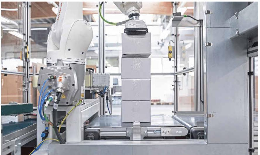
**Bild 3:** Das Greifsystem besitzt ein niedriges Eigengewicht und einen integrierten pneumatischen Vakuumerzeuger. Foto: J. Schmalz GmbH
