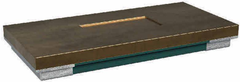
**Bild 2:** Shunts aus der FMx-Reihe bestehen aus einer Vollmetallplatte der Widerstandslegierung und können aufgrund dieses massiven Aufbaus hohe Pulsenergien gut absorbieren und nach außen abführen. Bild: Isabellenhütte Heusler GmbH & Co. KG
