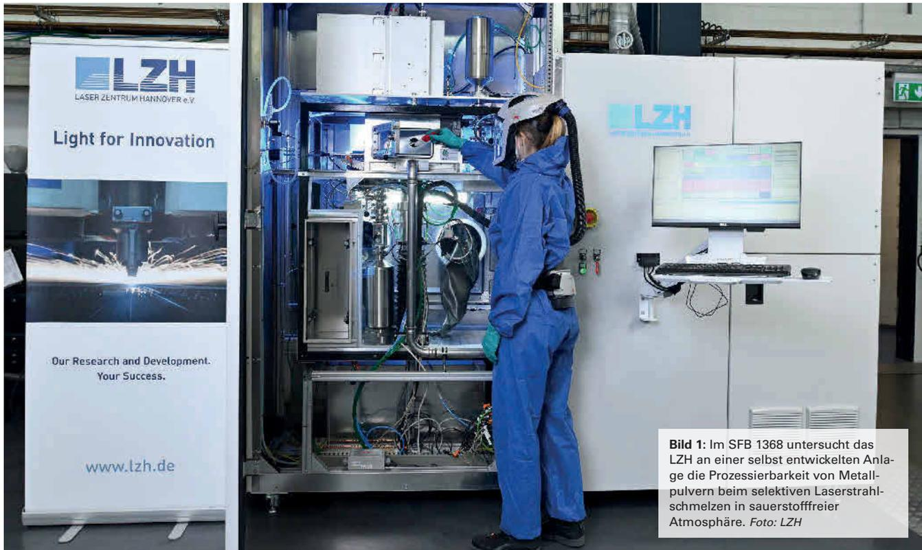
**Bild 1:** Im SFB 1368 untersucht das LZH an einer selbst entwickelten Anlage die Prozessierbarkeit von Metallpulvern beim selektiven Laserstrahlschmelzen in sauerstofffreier Atmosphäre. Foto: LZH
