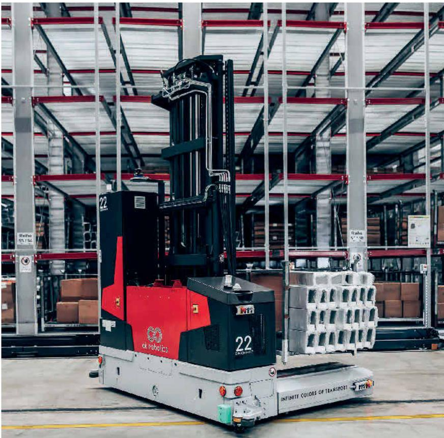
**Bild 4:** Zwei maßangefertigte 4-Wege-Stapler der Serie Custom Move lagern in Wertheim Waren in acht Metern Höhe im Verschieberegale ein. Foto: ek robotics
