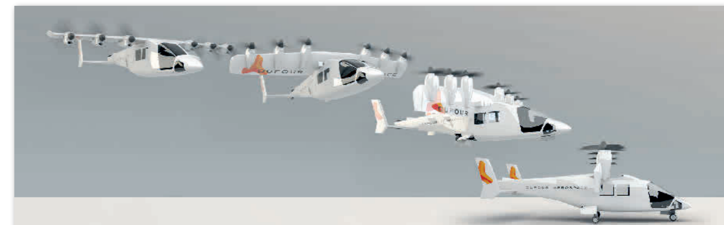
Choreografie beim Landeanflug: Das Fluggerät liegt während des Reiseflugs mit senkrechten Flügeln in der Luft. Kurz vor der Landung kippen die Tragflächen schrittweise um 90°, sodass das Fluggerät über der Landestelle schwebt. Nun wird die Flughöhe kontrolliert abgesenkt – wie bei einem Helikopter. Grafik: Dufour Aerospace
