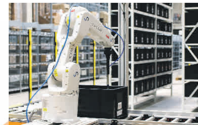
Roboter wissen dank der KI von Sereact, welche Produkte sie wo greifen sollen und wie sie gestapelt werden können. Angelernt werden müssen sie dafür nicht. Foto: Sereact
