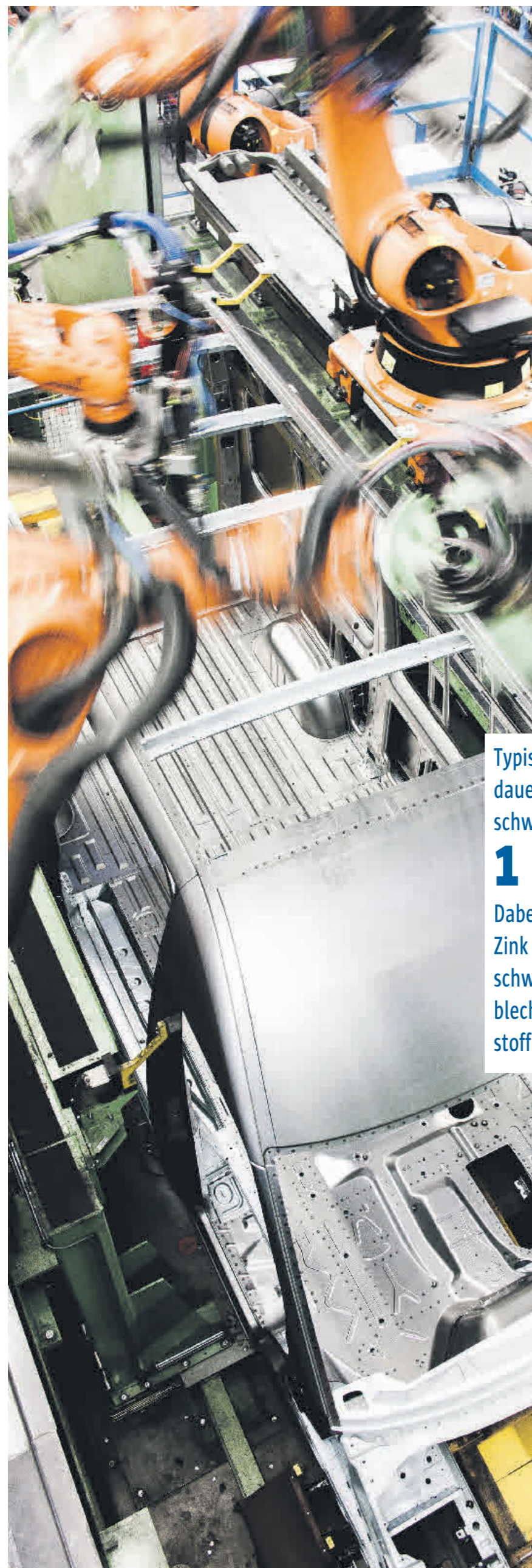
Klassischer Defekt: Beim Punktschweißen von verzinkten Karosserieblechen bilden sich rund um die Schweißstellen Mikrorisse. Wie es dazu kommt, darüber hat nun die BAM neue Erkenntnisse gewonnen. Foto: image images/Robert Poorten
