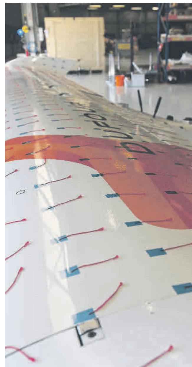
„Immer noch die beste Methode“: Das Team um Dufour-Chef Pfammatter prüft den Strömungsverlauf an den Tragflächen mit aufgeklebten Wollfäden. Foto: Armin Scharf
