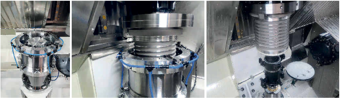
Bild 3. Das Semi-Schlichtwerkzeug für die Innenbearbeitung ist in der unteren Spindel gespannt und umschlossen vom glockenförmigen Außenwerkzeug (links). Bei der simultanen Bearbeitung wird das Werkstück von oben in den Ringspalt zwischen Außen- und Innenwerkzeug gefahren (Mitte). Ein Feinbohrwerkzeug dient zur Fertigbearbeitung aller Innendurchmesser (rechts). Foto: Niles-Simmons
