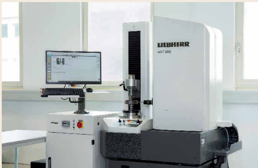
Bild 2. Die „WGT 280“ überzeugt durch mechanische Genauigkeit, Vielseitigkeit sowie die Anwenderunterstützung durch eine innovative, eigenentwickelte Software. Foto: Liebherr
