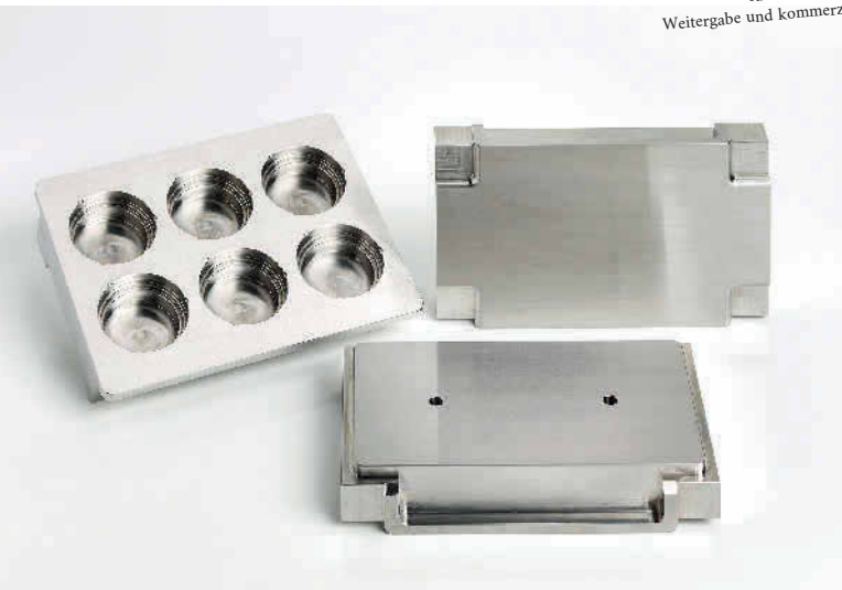
Anspruchsvolle Zerspaltung: HIN Feinmechanik fräst Komponenten für die Pharmaentwicklung aus dem durch Titanzusatz stabilisierten Edelstahlwerkstoff 1.4571 (links). Die Flansche (rechts) werden für den Rennsport in Kleinserien hergestellt. Foto: HIN/Hermle
