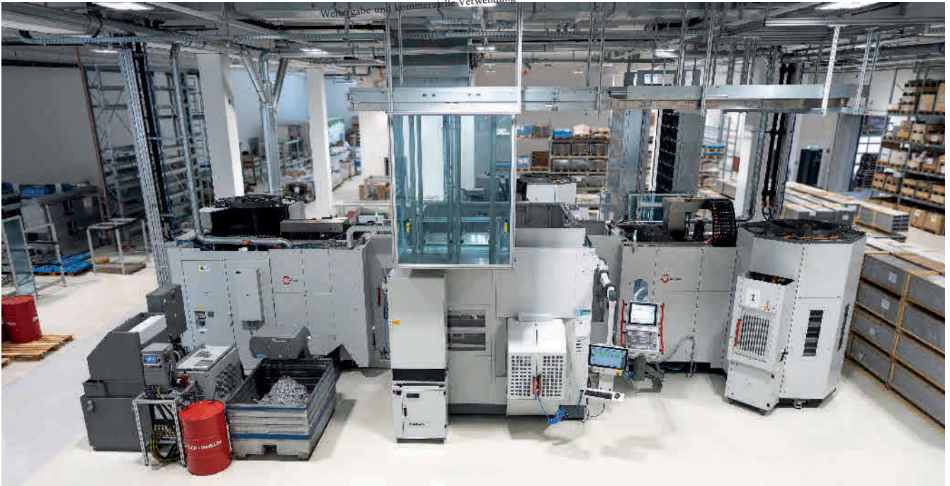
Blick in den Shopfloor bei Heron: Im modernen Maschinenpark in Dornbirn/A wird präzise und effizient gefertigt. Zur Ausstattung gehört ein Hermle-Bearbeitungszentrum „C32“ mit Roboterbeschickung. Foto: Z+G
