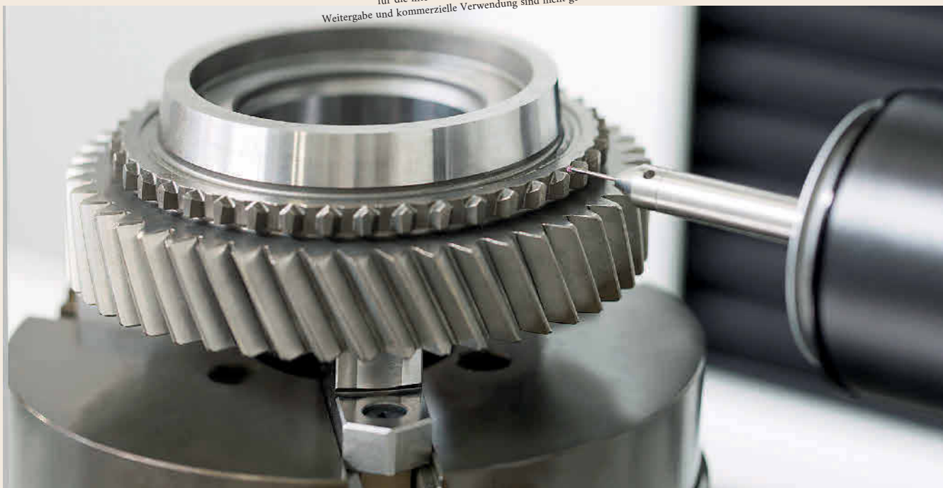
Die Baureihe „WGT“ misst beliebige Zahnräder, Wellengeometrien, Verzahnungswerkzeuge sowie andere rotationssymmetrische Werkstücke und wird vom Hersteller je nach Anforderung individuell konfiguriert. Foto: Liebherr
