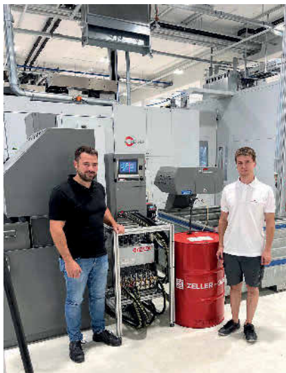
Bild 4. Phillip Götz ( Hydac , links) und Benjamin Moosbrugger ( Heron ): Gerade mittelständische Industriekunden wünschen sich vom Schmierstofflieferanten ein „Rundum-sorglos-Paket“. Das Fluidmanagementsystem „Fluid-Check Pro“ „trackt“ auch den Konzentratverbrauch und das benötigte Wasservolumen. Foto: Z+G
