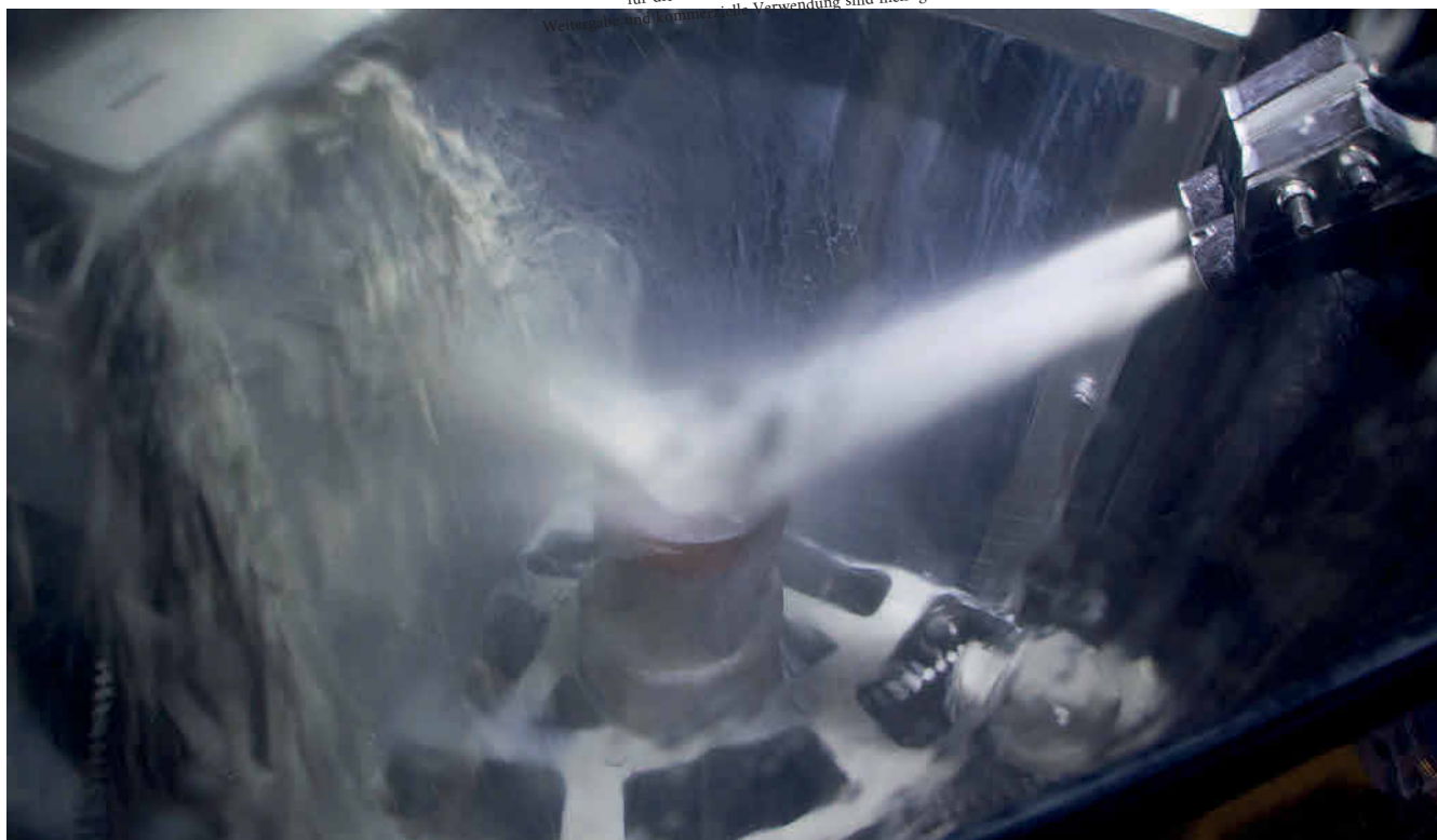
Beim Nassstrahlen wird ein Wasser/Strahlmittelgemisch zu einer Strahlpistole gepumpt, durch Druckluft beschleunigt und auf die Werkstücke geschleudert. Die Aufprallenergie erzeugt den gewünschten Effekt – sei es eine Reinigung, Oberflächenglättung oder Vorbereitung für das Beschichten. Foto: Rösler
