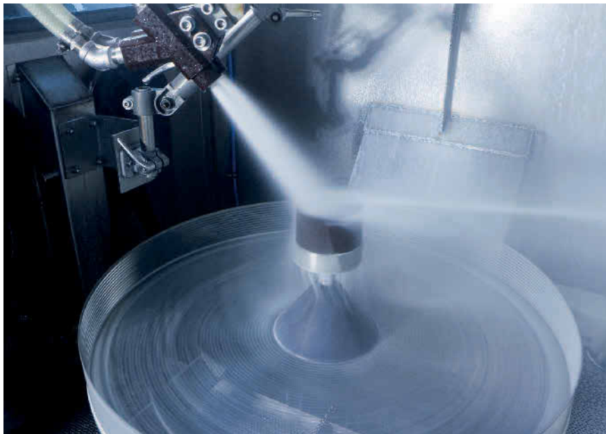
Bild 1. Nussstrahlen erzeugt glatte und präzise Oberflächen bei guter Reproduzierbarkeit. Die Technik ist dabei nicht nur flexibel einsetzbar, sondern auch besonders wirtschaftlich. Foto: Rösler
