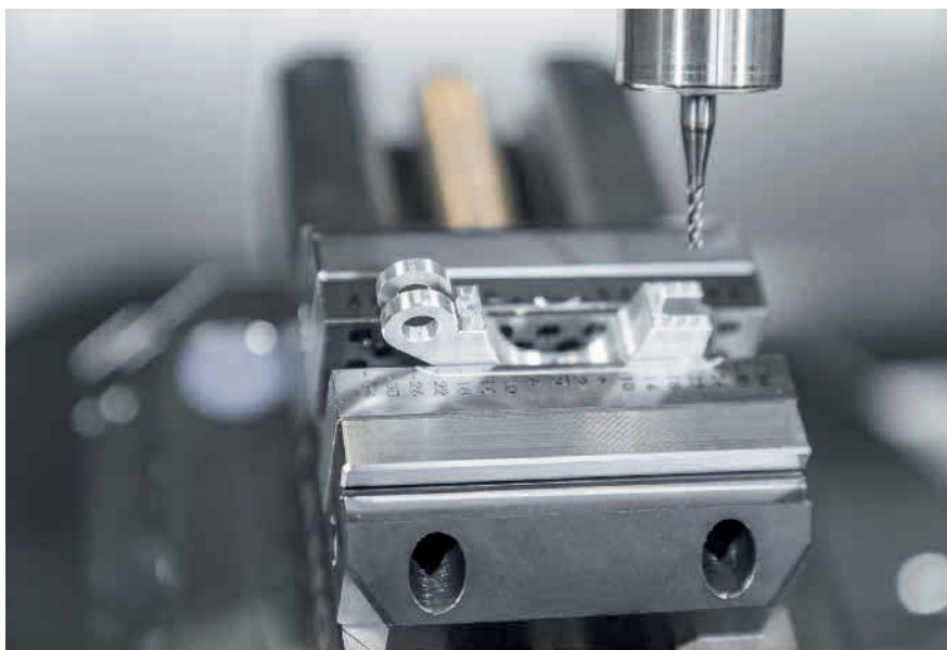
Bild 2. Ein Prototyp aus Aluminium in Bearbeitung auf der „C 250 U“. Foto: HIN/Hermle
