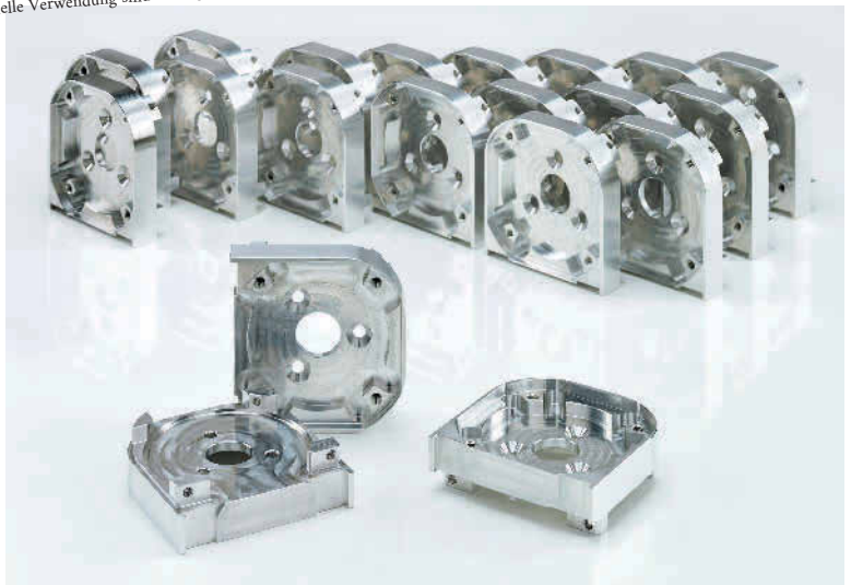
Anspruchsvolle Zerspaltung: HIN Feinmechanik fräst Komponenten für die Pharmaentwicklung aus dem durch Titanzusatz stabilisierten Edelstahlwerkstoff 1.4571 (links). Die Flansche (rechts) werden für den Rennsport in Kleinserien hergestellt. Foto: HIN/Hermle
