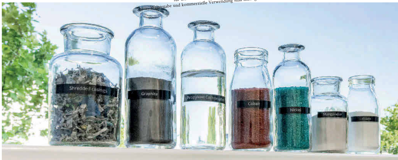
Die aus dem „Primobius“-Recyclingprozess herausgelösten Wertstoffe: Die Vermeidung von CO 2 -Emissionen über alle Prozessstufen hinweg wirkt sich positiv auf die Klimabilanz im Produktlebenszyklus eines Batteriemoduls aus – sowie des E-Fahrzeugs, in dem es eingesetzt wird. Foto: SMS
