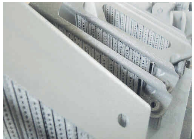
Die maßgefertigten Halterungen werden an verschiedenen Positionen des Aufbaus des Solarautos eingesetzt. Foto: Benseler
