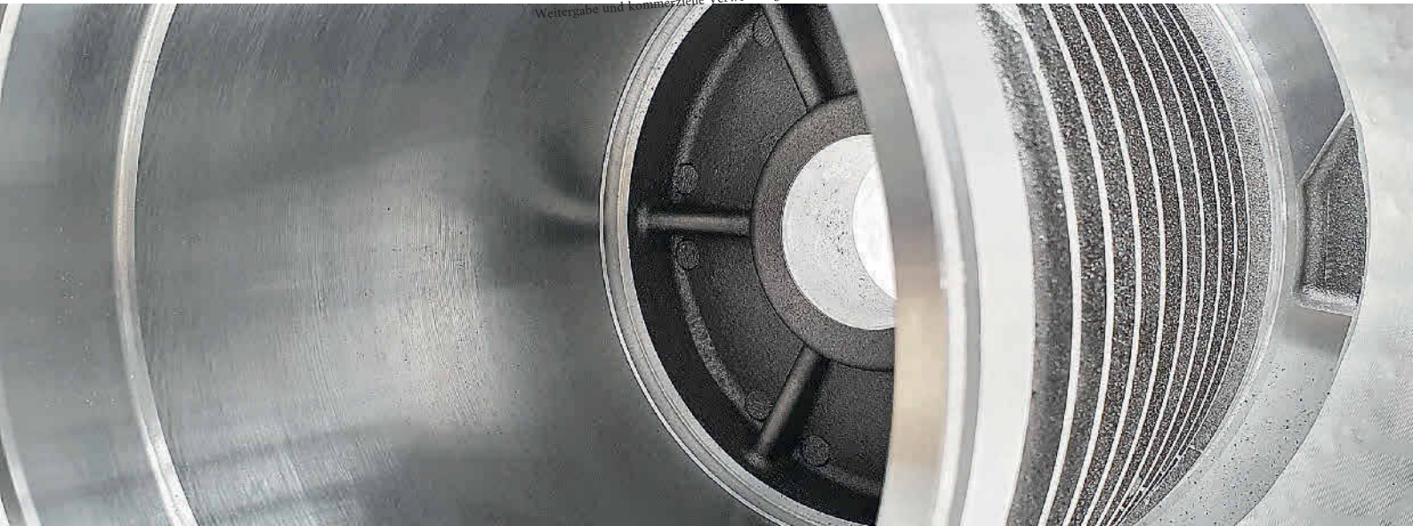
Die Zerspanung des Statorgehäuses umfasst die Innenbearbeitung mit verschiedenen Absätzen, die Bearbeitung der kleineren Mittenbohrung sowie die Bearbeitung der Außenseite mit ihren Kühlrippen. Foto: Niles-Simmons
