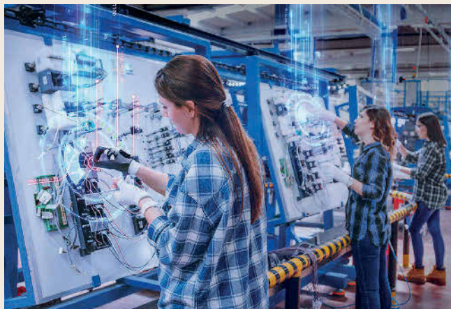
Ein „Wearable“ in Form eines sensitiven Handschuhs sorgt für die Digitalisierung manueller Montageschritte. Foto: Tacterion
