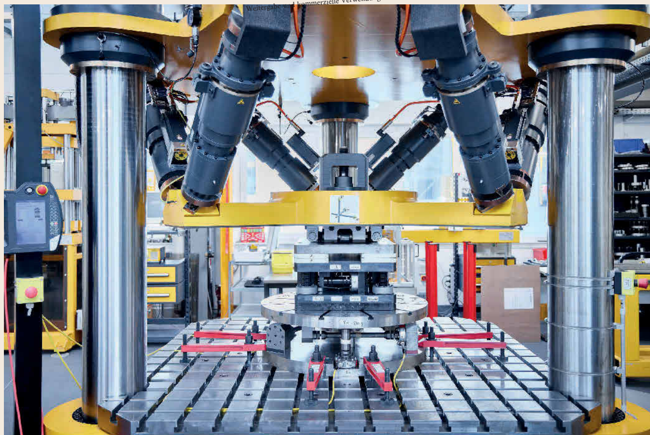
Einbauraum der Messeinrichtung während der Kalibrierung mit Messplattform und eingespanntem Prüfling. Alle Vektorachsen lassen sich gleichzeitig und vollautomatisch messen. Foto: GTM
