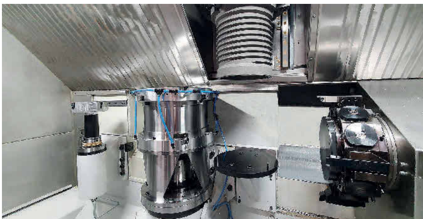
Bild 2. Arbeitsraum des mehrspindeligen Drehzentrums mit Werkzeugrevolver als vertikaler Maschinenaufbau. Foto: Niles-Simmons
