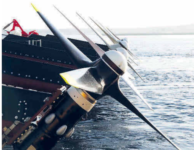
Bild 1. Spannender Anwendungsfall: Gezeitenkraftwerk mit einem Rotorblatt aus CFK (kohlenstofffaserverstärktem Kunststoff). Foto: Sustainable Marine Energy Ltd.
