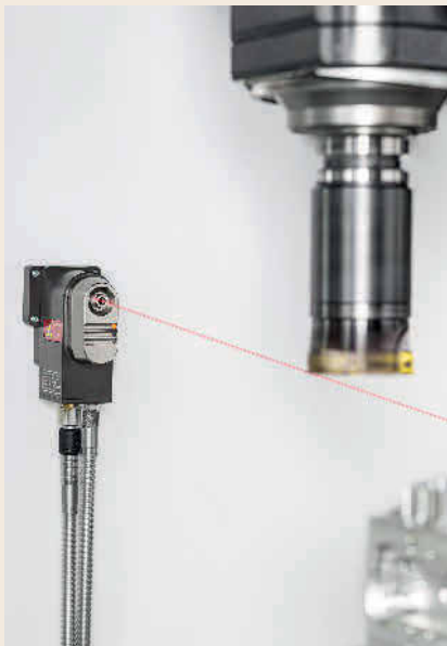
Bild 1. Das „LC53-Digilog“ kann flexibel an der Maschinenwand montiert werden, bietet eine hochpräzise Laseroptik und ein einzigartiges Schutzsystem. Foto: Blum-Novotest
