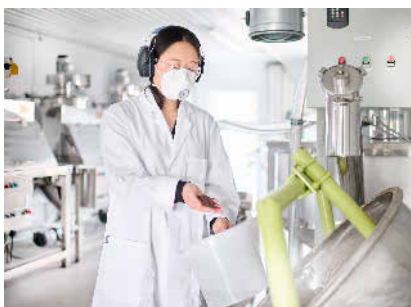
Projektingenieurin Rui Yue kontrolliert die Korngrößen nach der Granulation mittels Granulierteller in der Pontes Pabuli-Versuchsanlage. Foto: VKD
