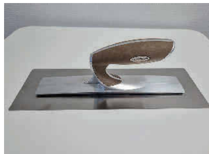
Ein Prototyp mit der neuen Griffform auf einer Druckmessplatte: Simuliert wird hier, wie sich der zentrische Druck des Griffes auf das Kellenblatt an einer Wand verteilt.
