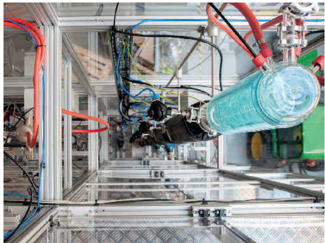
Blick von oben in die Demonstrationsanlage zur Herstellung von Oxymethylenether (OME) als Dieselsatz am Campus Straubing der Technischen Universität München (TUM). Foto: Jan Winter/TUM
