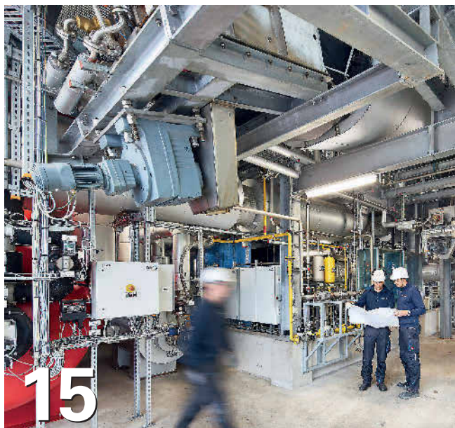
Aus Klärschlamm lässt sich neben Phosphor auch Synthesegas als Rohstoff für chemische Substanzen gewinnen. Dies zeigt ein neues Verfahren einer baden-württembergischen Firma. Foto: Kopf SynGas
