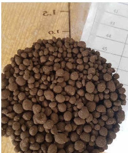
Ein Granulat , erzeugt nach dem Pontes Pabuli-Verfahren. Foto: VKD
