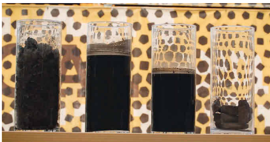
Schrittweise Anreicherung von Phosphor: Im linken Glasbehälter befindet sich Klärschlamm, in dem daneben das Hydrolysat, in dem sich fast aller Phosphor in löslicher Form befindet. Im dritten Reagenzglas von links ist das abgetrennte Prozesswasser zu sehen, in dem sich je nach Prozesseinstellung 60 bis 70 % des Phosphors befinden. Im rechten Reagenzglas ist die phosphorarme HTC-Kohle mit dem verbleibenden Phosphor. Foto: TerraNova Energy
