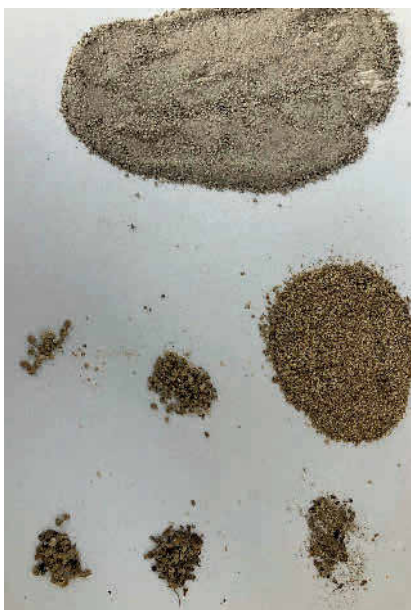
Verschiedene Struvite: Oben zu sehen ist im iPhos-Verfahren gewonnenes Struvit. Das Mineral ist feinkörnig (<1,4 mm) und weist kaum Fremdstoffe auf. Zum Vergleich sind in der Mitte drei Siebfractionen (von links nach rechts: >2,35 mm, <2,35 mm < 1,4 mm) eines Struvits zu sehen, das im Zentrat eines Anaerobschlamms ausgefällt wurde. Aus jeder Fraktion wurden die makroskopischen Fremdstoffe herausgesucht und unter die jeweilige Fraktion gelegt. Foto: SF-Soepenbergt
