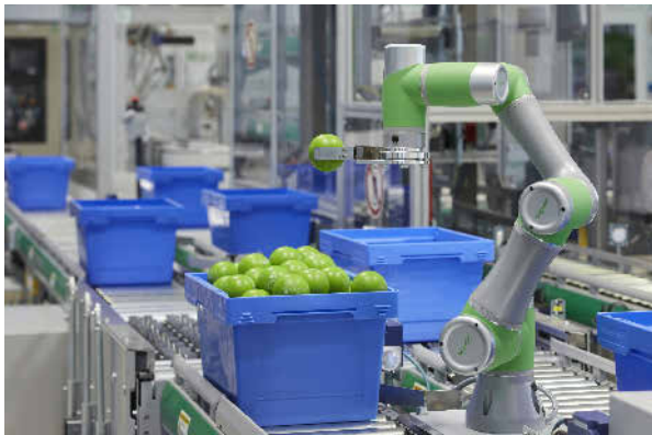
Ein „Lexium Cobot“ positioniert Objekte wie hier Plastikbälle sicher und zuverlässig. Foto: Schneider Electric
