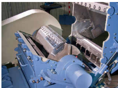
Die Kunststoffschneidmühle der neuen Schredderanlage (hier geöffnet) arbeitet mit rotierenden Messern. Foto: Pekutherm Kunststoffe
