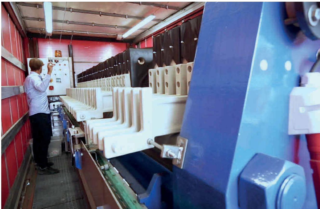
Die Kohlepresse der Demonstrationsanlage von TerraNova Energy im Klärwerk Duisburg. Die Presse wurde gerade geöffnet und die HTC-Kohle fiel nach unten hinunter. Zu sehen sind die schwarzen Filtertücher und weißen Filterplatten. Diese Kohlepresse hat etwa eine Kapazität für eine Kläranlage mit 60 000 Einwohnern. Foto: TerraNova Energy
