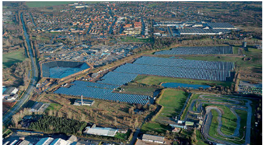
Im dänischen Vojens versorgt ein Erdbeckenspeicher gespeist mit Wärme aus einer Solarthermieanlage mit einer Kollektorfläche von 70 000 m 2 mehr als 2 000 Haushalte. Foto: Ramboll
