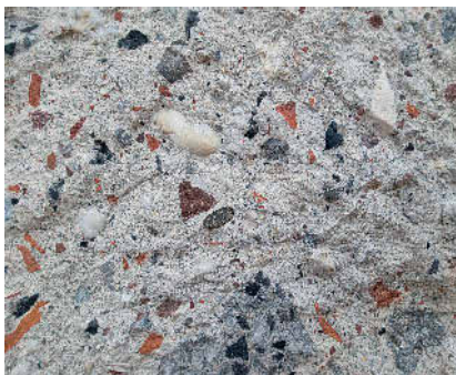
Im Recycling-Beton ist der klassische Bauschutt-Mix mit rotem Klinker sowie Anteilen von Ziegel, Beton- und Mauerwerk zu sehen.
