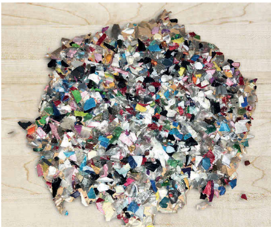
Eine typische bunte Mischung von geschredderten flexiblen Verpackungen. Die schwarzen Teilchen lassen sich heute auch nach der Art des Polymertyps sortieren. Foto: Stadler
