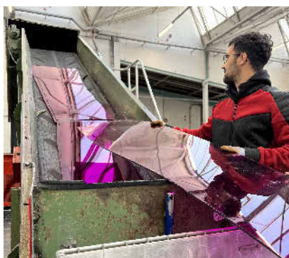
Buntes PMMA-Plattenmaterial eines ehemaligen Messestandes wird händisch der Zerkleinerung zugeführt. Foto: Pekutherm Kunststoffe
