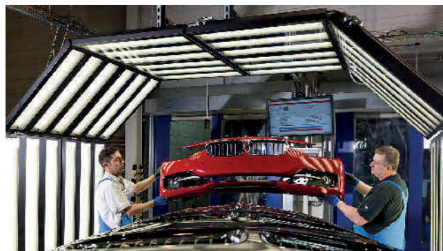
BMW-Mitarbeiter prüfen im Werk Landshut die Qualität eines Stoßfängers. Ein Ziel des FSCM-Projektes ist, hier den Anteil an Sekundärrohstoffen deutlich zu steigern. Foto: BMW
