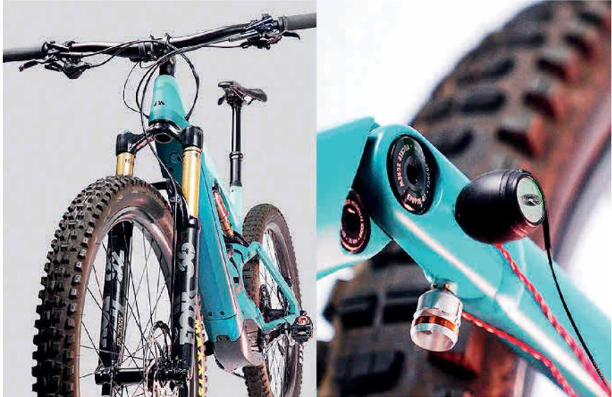
Hochspezialisierten Miniaturschwingungsanreger lassen sich in Bereichen realisieren, die das Anbringen eines Standardschwingungsanregers erschweren. Foto: Head acoustics / Qsources
