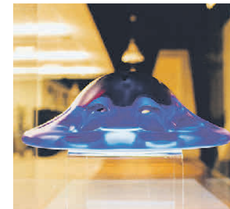
Der Biosensor in Form einer Qualle erfasst Gerüche und kann auch Sprengstoffe detektieren. Foto: Koniku Inc.
