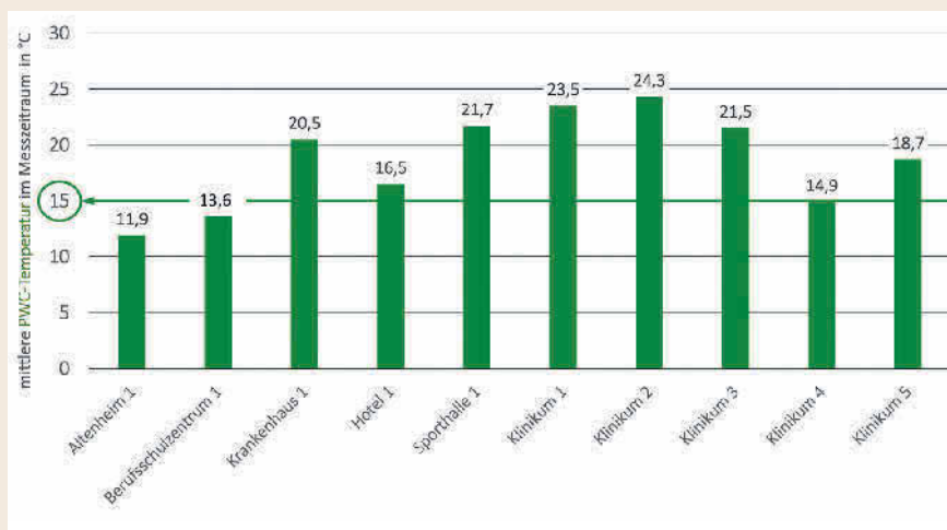
Bild 4: Mittlere Temperaturen des kalten Trinkwassers im Messzeitraum in der Hausanschlussleitung. Grafik: B. Harker
