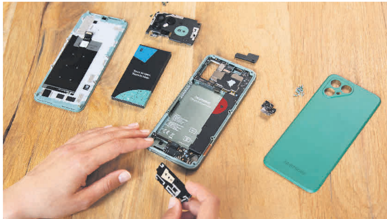
Reparaturfreundlicher Aufbau: Das Fairphone lässt sich dank seiner modularen Bauweise besonders einfach reparieren. Foto: Fairphone
