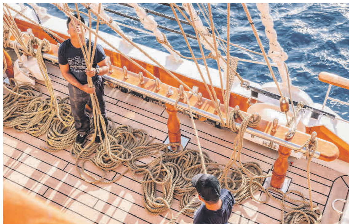
Eine Wissenschaft für sich: Die Segel auf dem Dreimast-Vollschiff werden mit Dutzenden von Leinen getrimmt. Jedes Tau hat seinen eigenen Namen und seinen eigenen Platz auf der sogenannten Nagelbank. Foto: Wolfgang Heumer
