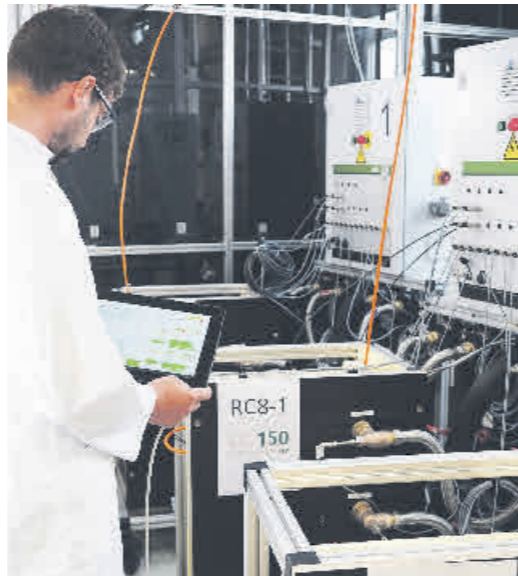
Propanbasierten Wärmepumpen: Das Fraunhofer-Institut für Solare Energiesysteme will den Einsatz von für Etagenheizungen prüfen. Foto: Fraunhofer ISE
