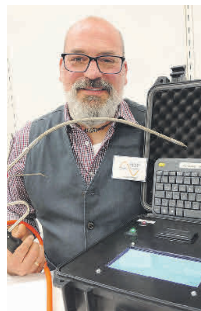
Der „NOxTER“ von Christian Straub erkennt illegale Manipulationen an Abgassystemen von Lkw sofort. Foto: S. Asche
