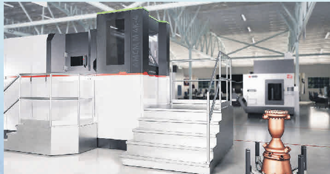
Höhenrausch: Der „M 4K“ der AMCM GmbH kann Bauteile aus dem Pulverbett zaubern, deren Ausdehnung in der z-Achse bis zu 1 m beträgt. Die US-Firma Launcher druckt damit komplette Raketentriebwerke. Foto: Launcher/AMCM
