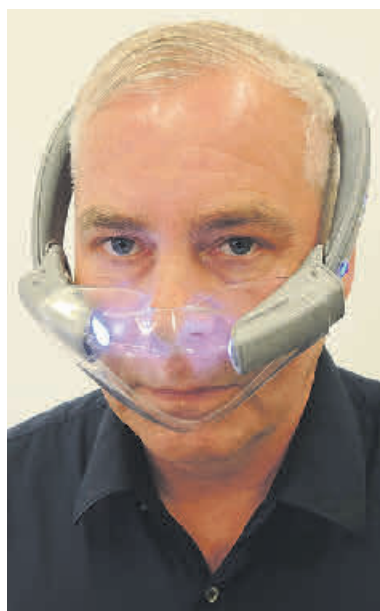
Für virenfreie Luft sorgt die Secure-Air-Maske vom Maschinenbau-Ingenieur Mario Spiewack aus Magdeburg. Mikroventilatoren und UVC-Licht machen es möglich. Foto: S. Asche
