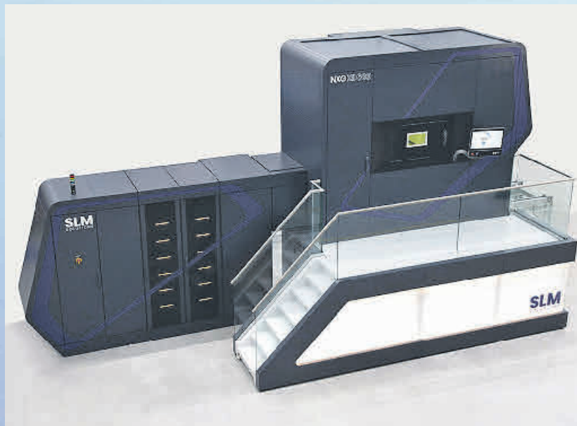
Voluminös: Der Bauraum des „NXG XII 600“ von SLM Solutions hat die Form eines Würfels. Dessen Kantenlänge misst 60 cm. Mehr Platz bietet keiner. Foto: SLM Solutions
