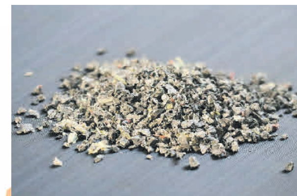
Die Eco-Flakes aus nicht recycelbarem Kunststoff werden dem Bitumen im Verhältnis 1:10 beigemischt. Asphaltwerke beziehen sie tonnenweise in Säcken. Foto: Ecopals
