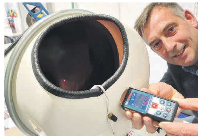
Den sekundschnellen Check eines Ausdehnungsgefäßes von Heizungen ermöglicht die Idee von Klaus-Dieter Will aus Eutin. Alles, was es braucht, sind eine integrierte Scheibe und ein Entfernungsmessgerät. Foto: S. Asche
