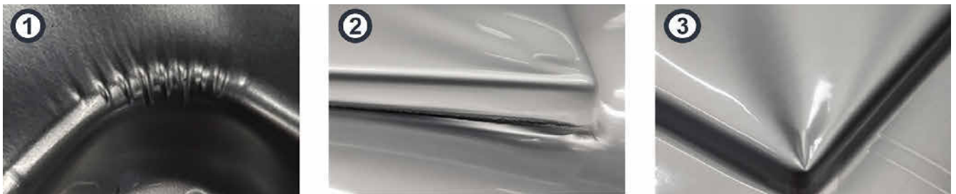
Bild 6. Fehlerbilder beim Pouchfolie-Tiefziehen: (1) Falten, (2) Risse, (3) Einziehungen. Foto: wbk
