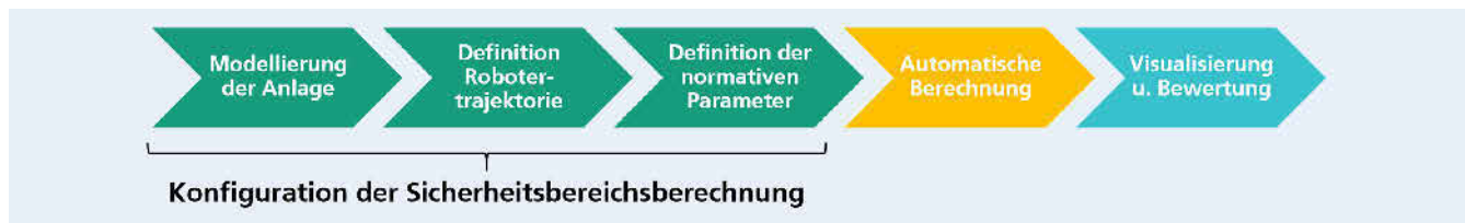
Bild 1. Vorgehensweise zur Berechnung applikationsspezifischer kompakter Sicherheitsbereiche. Grafik: IWU
