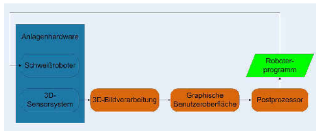
Bild 1. Systemkomponenten zur sensorbasierten Roboterprogrammierung. Grafik: Fraunhofer IGP
