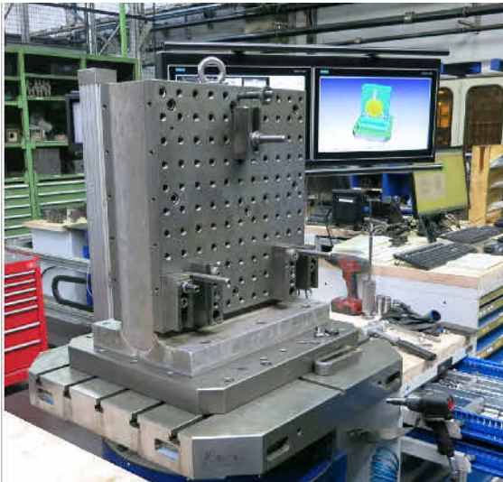
Bild 3. Rüstplatz mit indirekter AR zur Montage von modularen Spannsystemen mit quadratischen Grundplatten. Links: Grundfläche 900 x 900 mm 2 , rechts: Grundfläche 600 x 600 mm 2 . Foto: IFF / FMA
