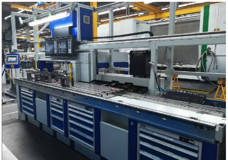
Bild 4. AR-Assistenzsystem für große modulare Spannsysteme. Links: auf einer Linearachse verschiebbare Touch-Screen-Einheit. Rechts: Gesamtsystem für Grundplatten bis insgesamt 3780 x 500 mm 2 (zwei von drei Grundplatten aufgelegt). Foto: IFF / FMA
