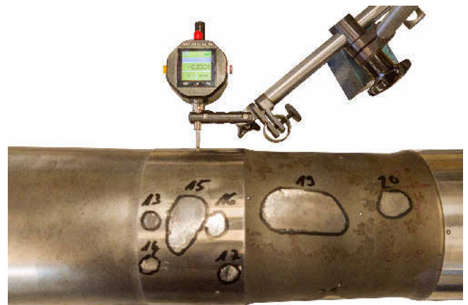
Bild 7. Vermessung der Reparaturstellen. Foto: TU Hamburg
