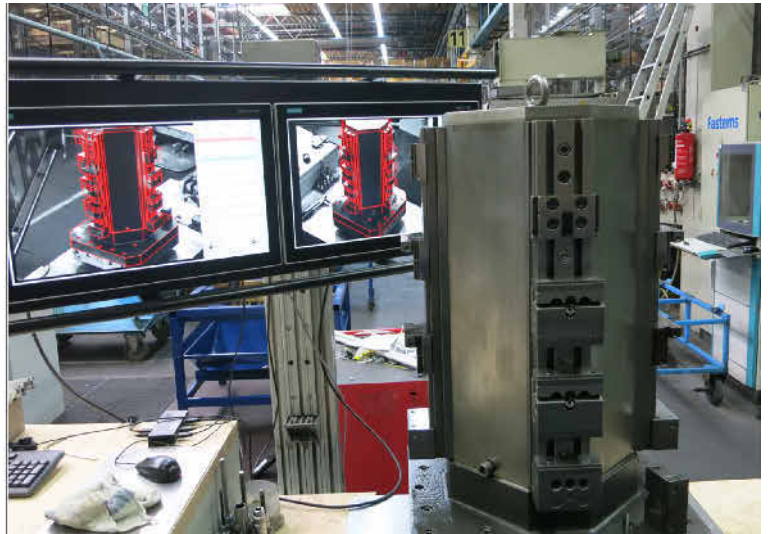
Bild 3. Rüstplatz mit indirekter AR zur Montage von modularen Spannsystemen mit quadratischen Grundplatten. Links: Grundfläche 900 x 900 mm 2 , rechts: Grundfläche 600 x 600 mm 2 . Foto: IFF / FMA
