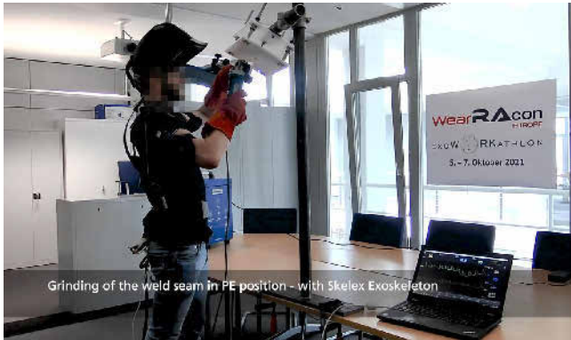
Bild 5. Darstellung der Schleifsequenz nach dem Auftragen einer Schweißnaht, in der Position PF (Werkstück über dem Kopf). Der Proband trägt das Exoskelett „Skel-Ex 360 XFR“. Foto: Fraunhofer IPA
