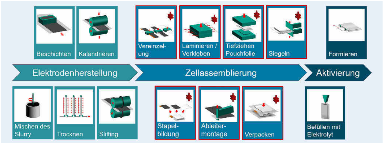
Bild 1. Prozesskette der Pouchzellen-Produktion. Grafik: wbk
