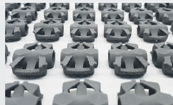
Serienfertigung möglich: Mit der „Cold Metal Fusion“ lassen sich kleinere Teile, etwa Fahrradpedale, in kurzer Zeit dutzendfach ausdrucken. Foto: Headmade Materials
