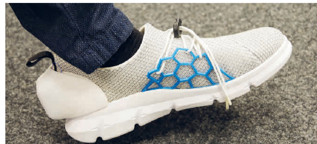
Spezialanfertigung: In einer Kappe an der Ferse des „Reha-Schuhs“ werden die Daten der Sensoren gesammelt und zur Auswertung übertragen. Foto: Rudolf Stumberger
