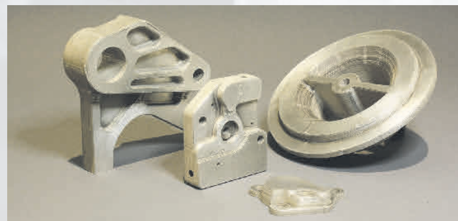
Viele Bleche ergeben ein Bauteil: Die per Lasercutter geschnittenen Schichten werden mittels Diffusionsschweißen gefügt. Foto: Alloy Enterprises
