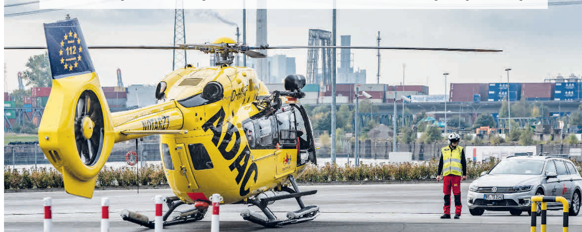
Notruf Hafenkante: Der Rettungshubschrauber Christoph 26 hat bei seiner Landung den autonom fahrenden VW Passat des DLR zum Bremsen gezwungen und in seine Parkposition dirigiert. Im Hamburger Hafen demonstrierte das Deutsche Zentrum für Luft- und Raumfahrt die Möglichkeiten der direkten Kommunikation zwischen Luft- und Bodenfahrzeugen (Air2X), um den Straßenverkehr sicherer zu machen. Foto: Wolfgang Heumer
