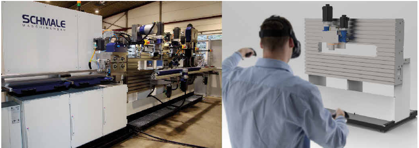
Bild 2. Drahtbiegeanlage und deren Konfiguration in Virtual Reality. Bild: Schmale Maschinenbau GmbH; TU Chemnitz, PSP
