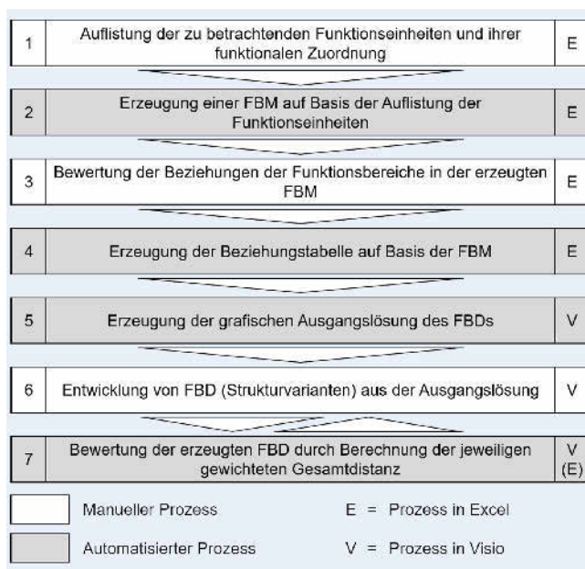
Bild 1. Methodenablauf in der digitalen Umsetzung. Bild: Fraunhofer IPA
