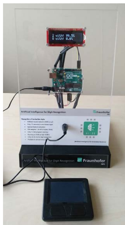
Bild 1. „AlfES“-Demonstrator zur Handschriften-erkennung. Alle Funktionen sind auf dem Arduino UNO integriert. Dieser liest die Sensorwerte des Touchpads ein, führt die Ziffernerkennung durch und gibt das Resultat über den Display aus. Bild: Fraunhofer IMS
