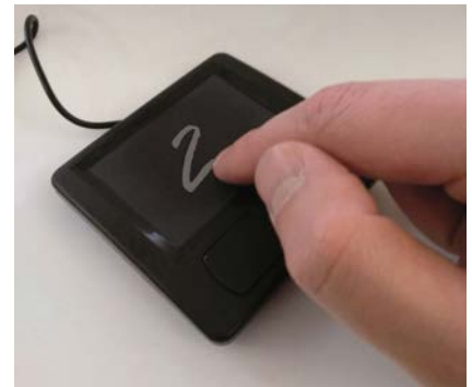
Bild 4. AlfES-Demonstrator zur Handschriftenerkennung. Auf diesem PS/2-Touchpad werden die Ziffern mit der Hand gezeichnet und dann vom Mikrocontroller erkannt und ausgegeben.
