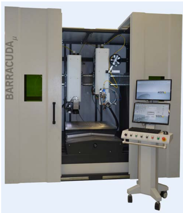
Bild 4. Anlagendemonstrator mit integrierter Messtechnik, Lasergravursystem, Laserschweißsystem und kraft geregelter Drahtvorschub. Bild: Acsys Lasertechnik
