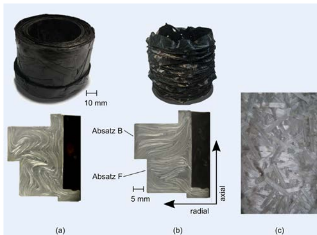
Bild 2. Darstellung der Vorformlinge und der Faserorientierung im gepressten Bauteil. Die Vorformlinge werden händisch um ein Rohr (Durchmesser circa 60 mm) gewickelt (a) Vorformling mit radialem Aufbau. Die Fasern orientieren sich in axialer und tangentialer Richtung; (b) Vorformling mit axialem Aufbau. Die Fasern orientieren sich in radialer und tangentialer Richtung; (c) HexMC-Halbzeug. Bild: PTW, TU Darmstadt
