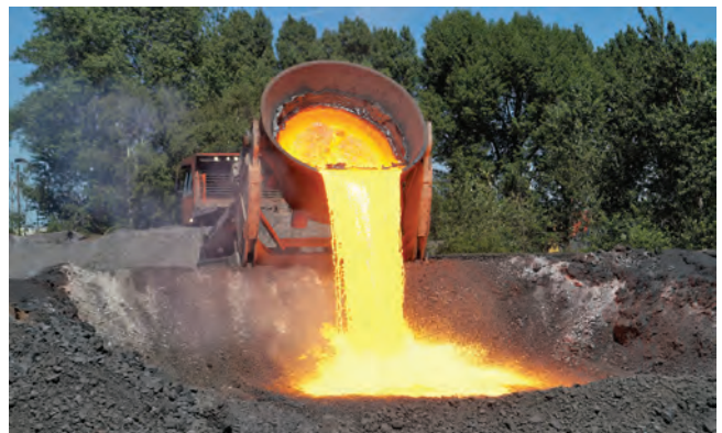
Aus lavaähnlicher Schlacke entsteht nach Abkühlen, Brechen und Sieben besonderer Splitt für Straßen mit hoher Belastung. Bild: HRV
