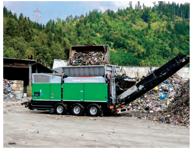
Der Zerkleinerer mit dem passenden Namen „Terminator“ zerkleinert auf dem Gelände der Mayer Recycling GmbH in St. Michael, Obersteiermark, unterschiedlichste Materialien wie Haus- und Gewerbemüll. Bild: Komptech
