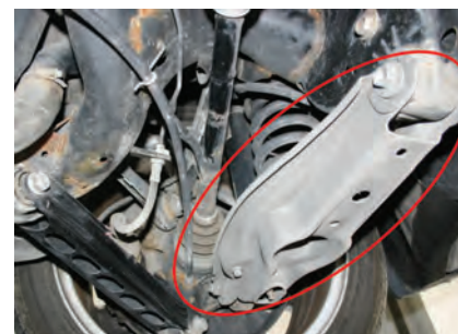
Ein Sturzlenker - eine Unterfahrwerkskomponente - mit einer microZinc-Beschichtung sieht nach 200.000 km Fahrleistung noch fast wie neu aus. Bild: Zinq Technologie
