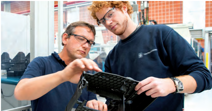
Recyclingmaterial wird in Haltern , die in Fahrzeugen verbaut werden, um etwa Elektronikkomponenten zu fixieren, eingesetzt. Bild: Pöppelmann
