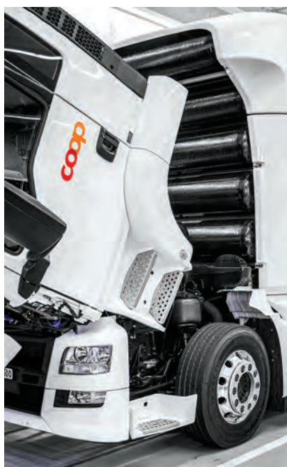
Der Hochdruckspeicher für Wasserstoff ist direkt hinter dem Fahrerhaus verbaut.
