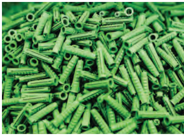
Fischers grüne Dübel bestehen aus einem Polyamid. Eine Komponente, die mehr als 60 % des Amids ausmacht, ist Sebacinsäure, die aus Rizinusöl aus dem Samen des Wunderbaums hergestellt wird. Bild: Fischer
