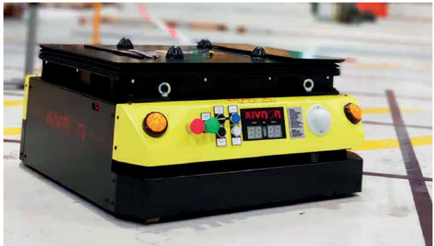
Bild 3 Bei Faurecia wird das Kivnon FTF K05Twister eingesetzt. Bild: Kivnon
