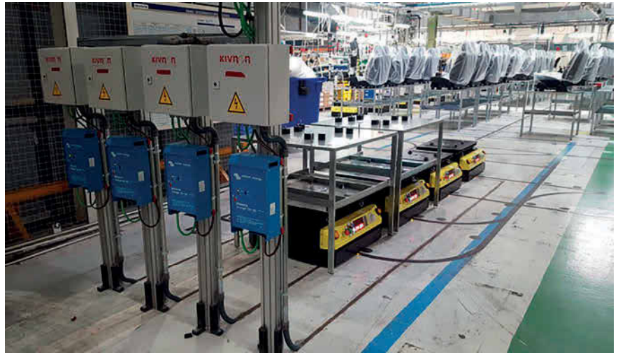
Bild 2 Dank der integrierten In-Line-Ladestationen arbeiten die FTF rund um die Uhr. Bild: Kivnon
