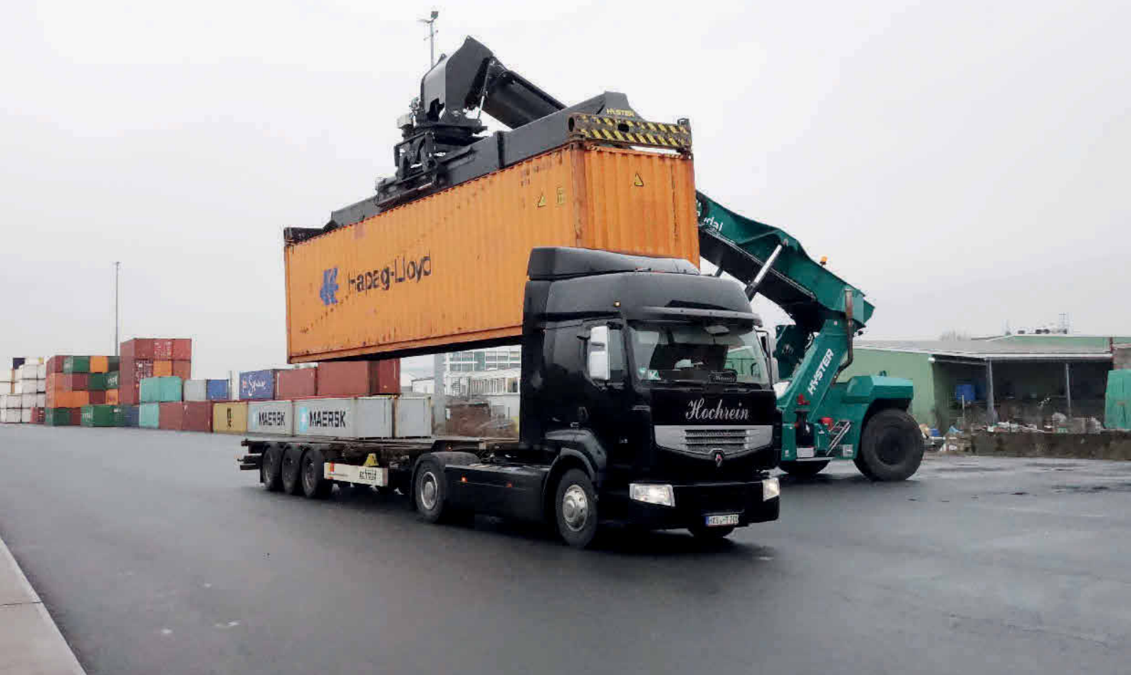
Bild 2 Container aus Oberfranken werden direkt per Reachstacker entladen und umgeschlagen. Bild: Hyster
