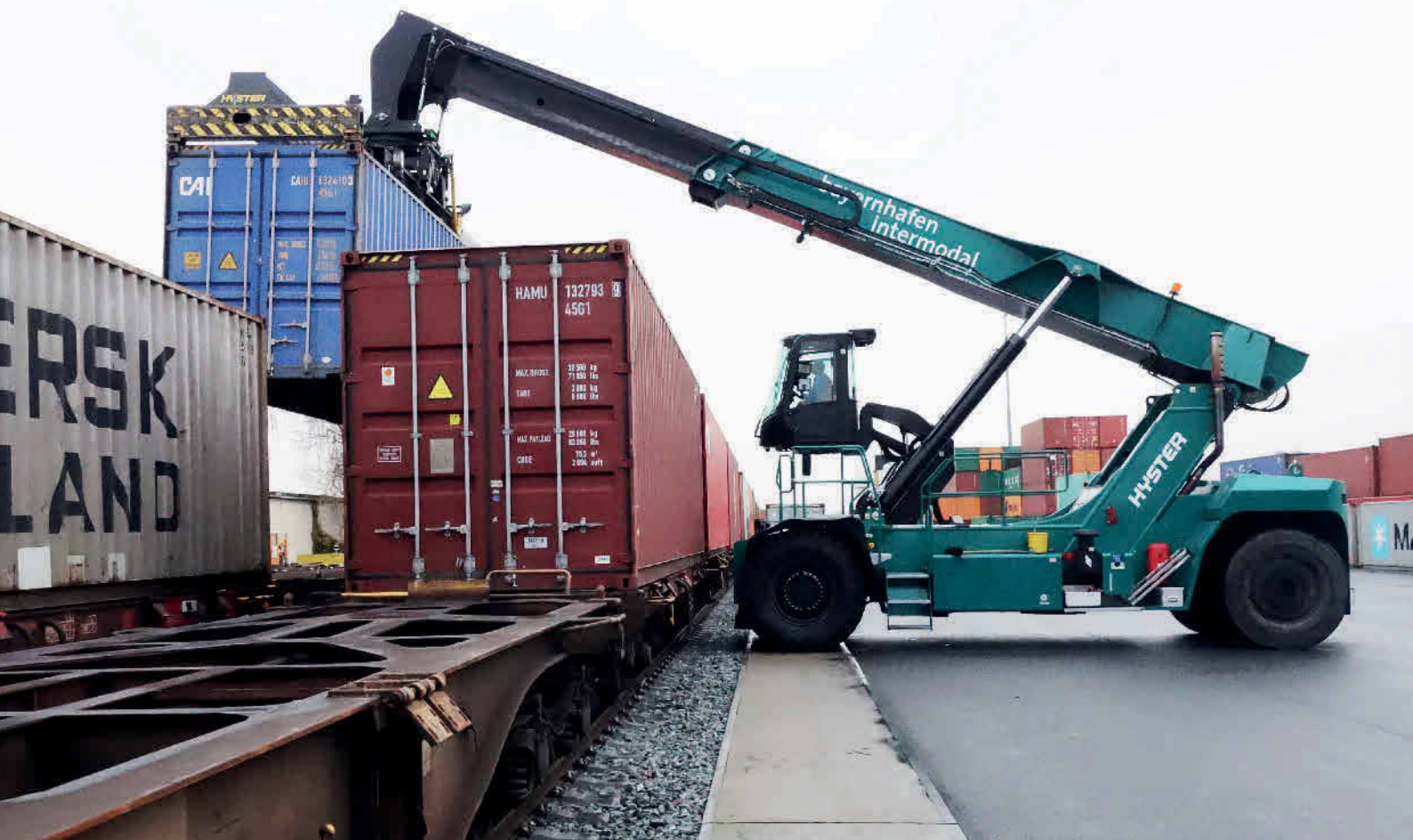
Bild 1 Die hochgefahrere Gelenkkabine ermöglicht dem Fahrer eine bessere Sicht auf Container in der zweiten Reihe. Bild: Hyster
