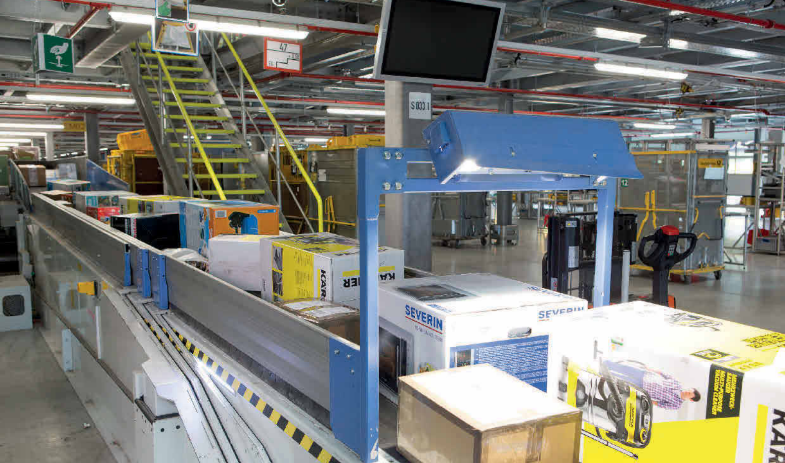
Bild 2 Das Transnorm-Singulation Concept ermöglicht undefinierte 3D-Entladungen der Transportfahrzeuge. Bild: Transnorm
