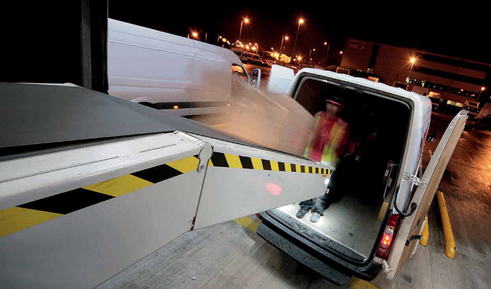
Bild 1 Für eine Beschleunigung der Transportlogistik können mit absenkbaren vorderen Teleskopsegmenten selbst kleinere Transporter bedient werden. Bild: Transnorm
