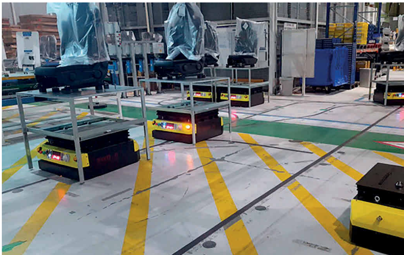
Bild 1 Rotative FTF mit Hubtisch kooperieren im Faurecia-Werk im spanischen Vitoria-Gasteiz mit Mitarbeitern am gemeinsam genutzten Arbeitsplatz. Bild: Kivnon
