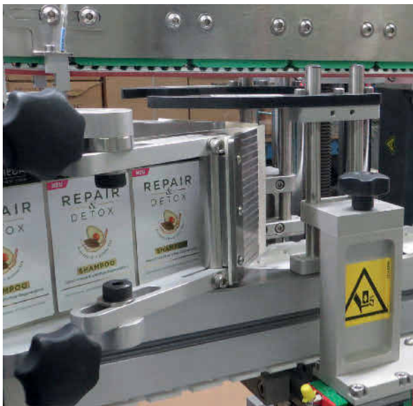
Dank des Geset 314 mit Orbiter von Bluhm Systeme werden die Vorder- und Rückseitenetiketten mit einer 100 %igen Etikettiergenauigkeit aufgebracht. Bild: Bluhm Systeme GmbH
