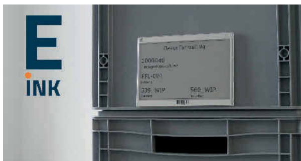
Die elektronischen Label können unterschiedliche Elemente anzeigen, wie etwa Bilder, Text, Zahlen oder Barcodes. Bild: Flexus AG
