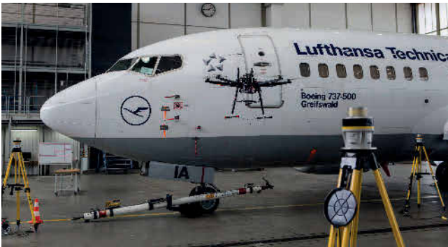
Validierung der Multikopter-basierten Oberflächeninspektion am realen Flugzeug. (Bild: IRT / WZL)
