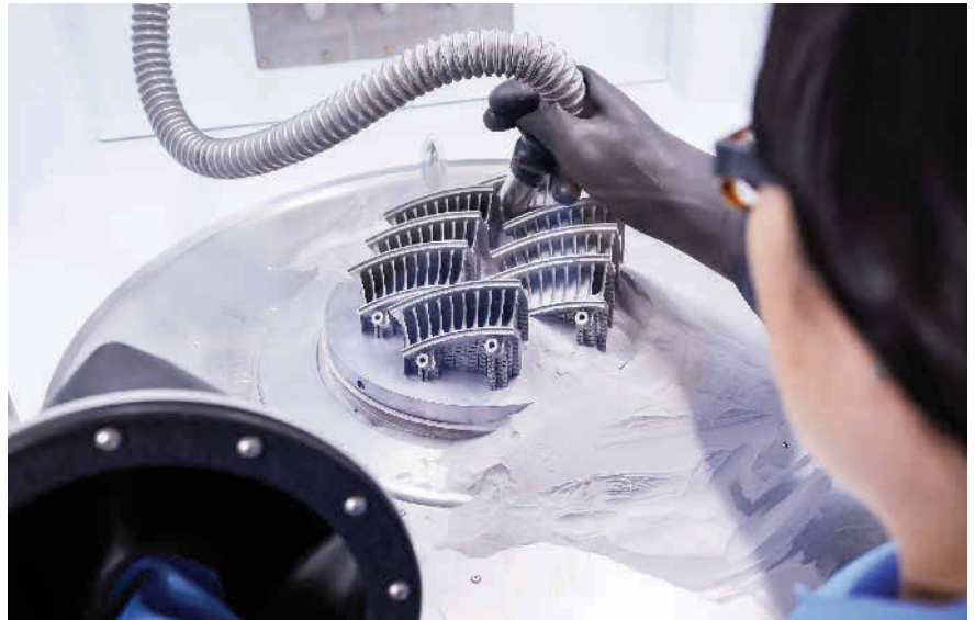
Bild 2 Im Auftrag von Toolcraft hat Trumpf ein Vane, das bei Flugzeugmotoren zum Einsatz kommt, mittels 3D-Druck hergestellt. Gesamtkostenersparnis: 20 Prozent. (Bild: Trumpf)
