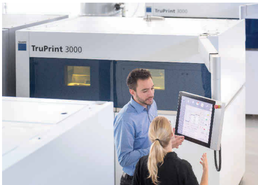
Bild 1 Der 3D-Drucker „TruPrint 3000“ eignet sich für die Fertigung hitzebeständiger Materialien. (Bild: Trumpf)
