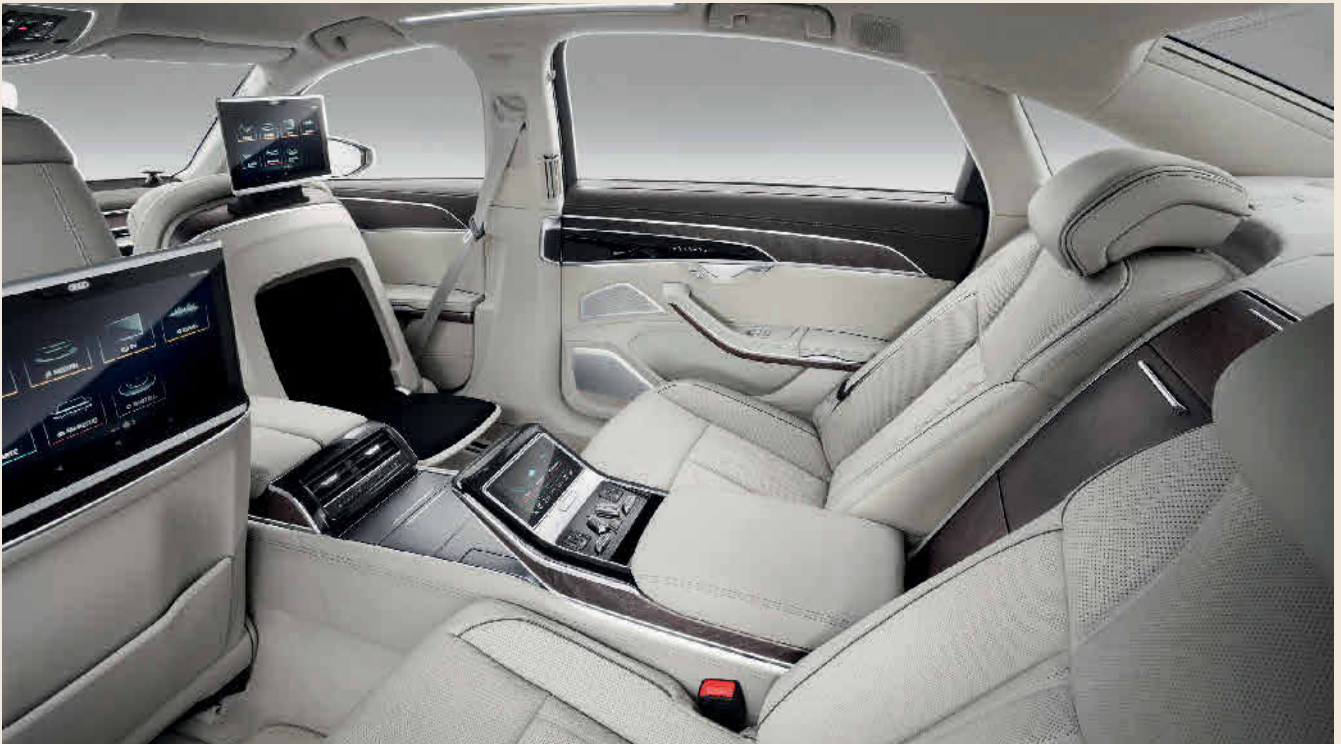
Bild 2 Der Audi A8 wird auch mit zwei elektrisch einstellbaren Einzelsitzen angeboten, deren Sitzschalen von Faurecia Automotive Seating entwickelt wurden und im Hybrid Molding-Verfahren gefertigt werden.
