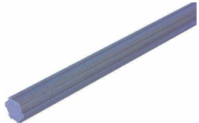
Mit neuen Keilwellen aus 42CrMo4-Vergütungsstahl erweitert Mädler sein Sortiment an sofort lieferbaren Keilwellen in Längen bis 6000 mm. Ihre maximale Geradheit beträgt 0,8 mm/m und die Torsion max. 0,5 mm/m. (Bild: Mädler)
