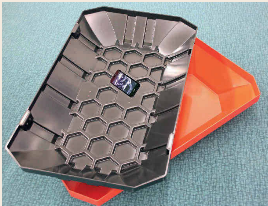
Bild 1 Robuste, zweiteilige Transportunterlage für den Maschinenbau. Mehrweg-Unterschale aus schlagzähem, chemisch beständigem HDPE sowie bauteilspezifischer Einweg-Transporteinsatz aus ABS.
