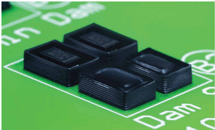
Bild 3 Ermöglicht den Bau filigraner Strukturen um Chips oder Sensoren: Dam-Klebstoff für die Elektronik. (Bild: Delo)
