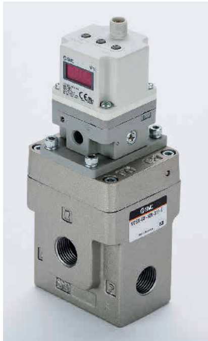
Bild 2 Minimieren Leckage auch im Ruhemodus: Die Standby-Ventile der Serie VEX1500/1700 von SMC reduzieren bei Betriebspausen, etwa zum Werkzeug- oder Schichtwechsel, automatisch den Druck einer Anlage und sparen so Druckluft und Energie. (Bild: SMC)
