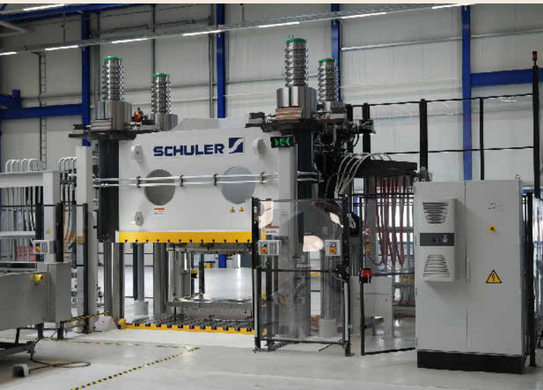
Die Unterkolben-Kurzhubpresse stellt ihre volle Presskraft von 2.500 Tonnen schon nach 0,14 Sekunden zur Verfügung.
