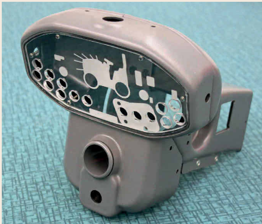
Bild 6 Traktor-Lenkradabdeckung. Aufwendige, mehrteilige Baugruppe aus vier Tiefziehteilen aus zweischichtigem ABS (außen Frischware, innen Recyclat), gefräst, geschweißt, mit Gewindeeinsätzen und eingeklebter Plexiglas-Frontscheibe versehen.
