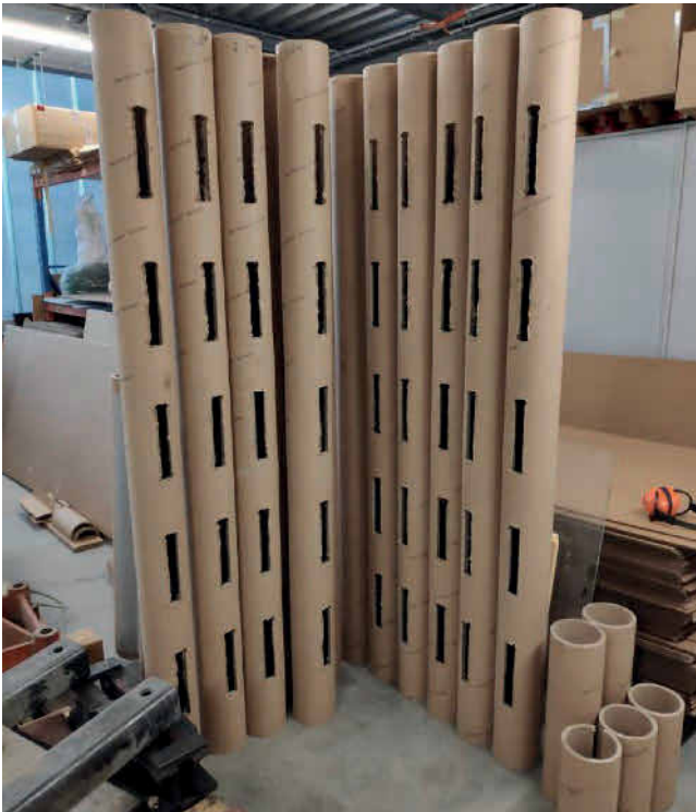
Bild 6. Hauptträger: Stege aus Wellpappe (a) und Gurte aus Papierhülsen (b) Abb.: F. Rieß Fig. 6. Main girder made of corrugated cardboard (a) and flanges from cardboard tubes (b) Source: F. Rieß
