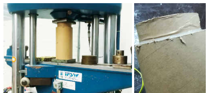
Bild 8. Experimentelle Tragfähigkeitsbestimmung des Rohrstoßes Abb.: F. Rieß Fig. 8. Test of compressive strength of a tube connection Source: F. Rieß
