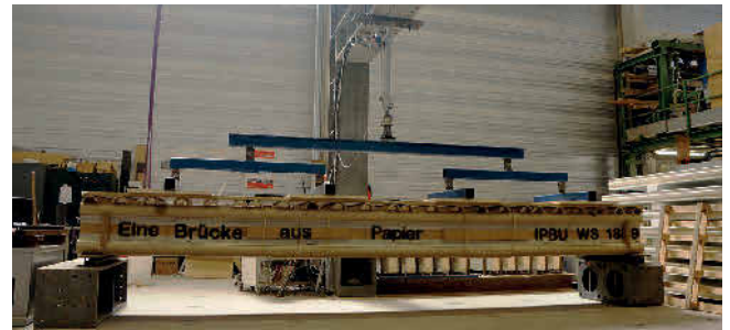
Bild 14. Traglastversuch Abb.: E. Kanli Fig. 14. Ultimate load test Source: E. Kanli
