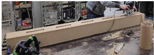
Bild 10. Herstellung der Gurtschlitzte mithilfe einer Schablone und einer Oberfräse Abb.: S. Laukhart Fig. 10. Fabrication of the slits for the web-flange connection with a template Source: S. Laukhart
