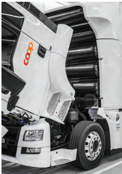
Der Hochdruckspeicher für Wasserstoff ist direkt hinter dem Fahrerhaus verbaut. Bild: Coop
