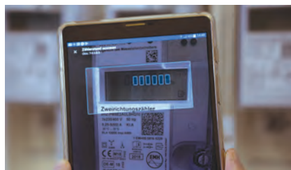
Ein Zählerstand wird mit der Anyline-App eingescannt. Bild: Anyline
