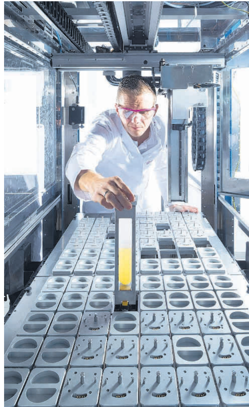
Substanzbibliothek: Ein Mitarbeiter bestückt die Anlage mit den Additiven, die später im vollautomatischen Durchlauf getestet werden. Foto: Evonik
