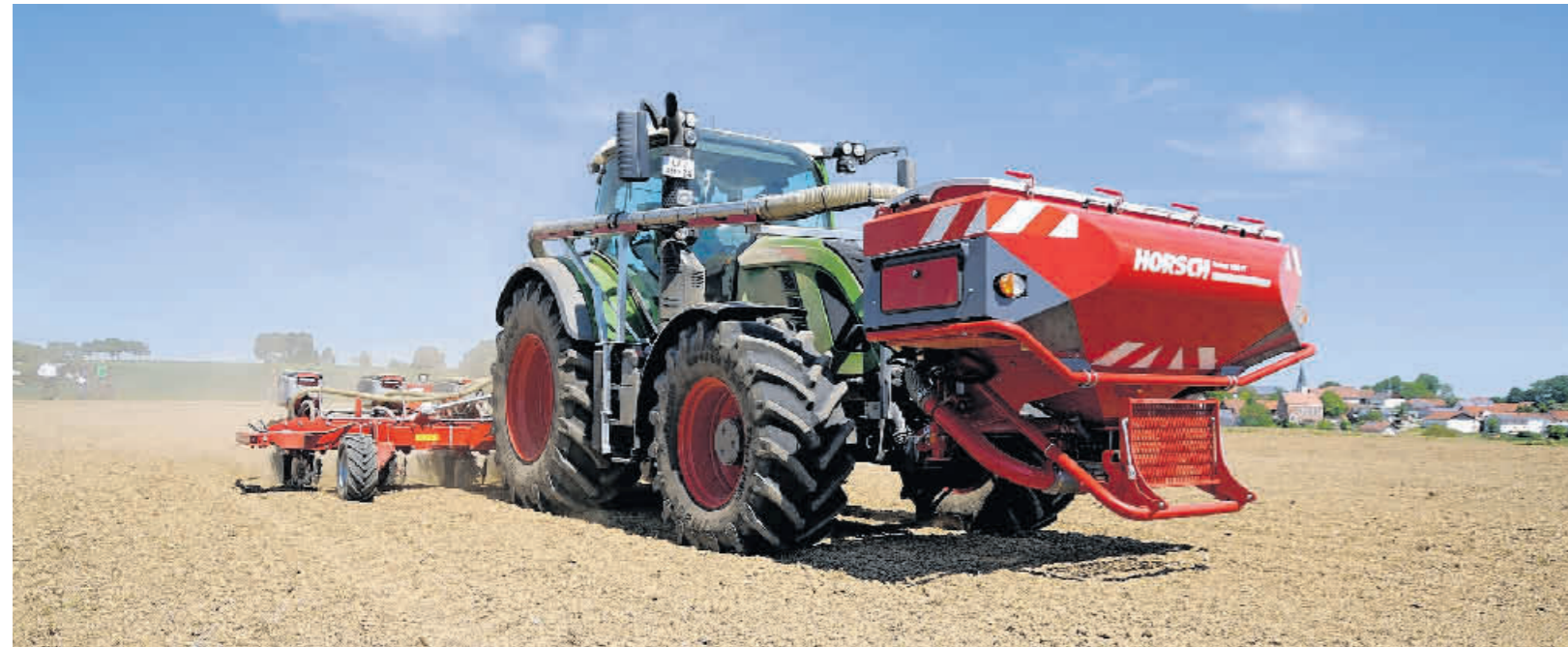
Dank GPS-Navigation und Satellitendaten bringt das Anbaugerät die Maiskörner auf 2,5 cm genau an die in der Aussaatkarte vorgegebene Position in die Erde. Foto: Carmen Rudolph
