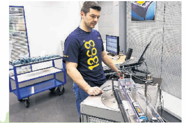
Qualitätssicherung: Drehmomentschlüssel werden bei Hazet in einem eigenen Labor kalibriert. 80 % seiner Produkte fertigt das Unternehmen selbst. Foto: Hazet
