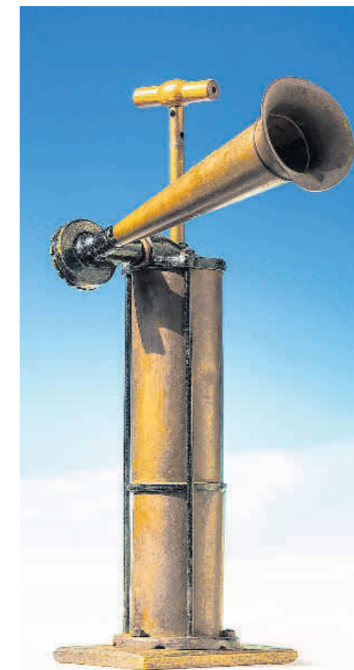
Nebelhörner erzeugen ihren Klang wie eine Klarinette und senden ihn in eine Richtung aus wie eine Trompete. Foto: SdtB / C. Kirchner
