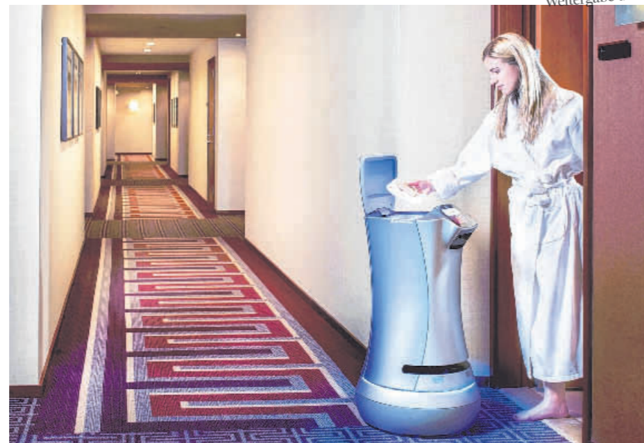
Hotelbote: Typische Lieferaufgaben in Hotels können Serviceroboter wie dieser übernehmen. Das Transportfach öffnet sich dabei erst, wenn die Zimmertür aufgeht. Foto: Savioke
