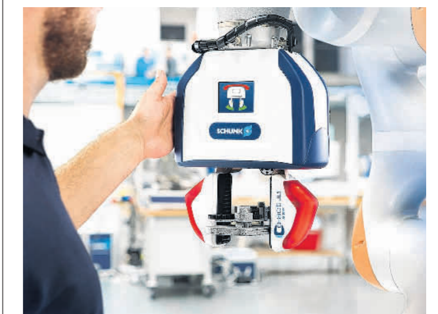
Technologieträger: An dem mit Sensoren und Leuchtsignalen ausgestatteten Greifer wird erprobt, was Praktiker benötigen. Foto: Schunk GmbH & Co. KG
